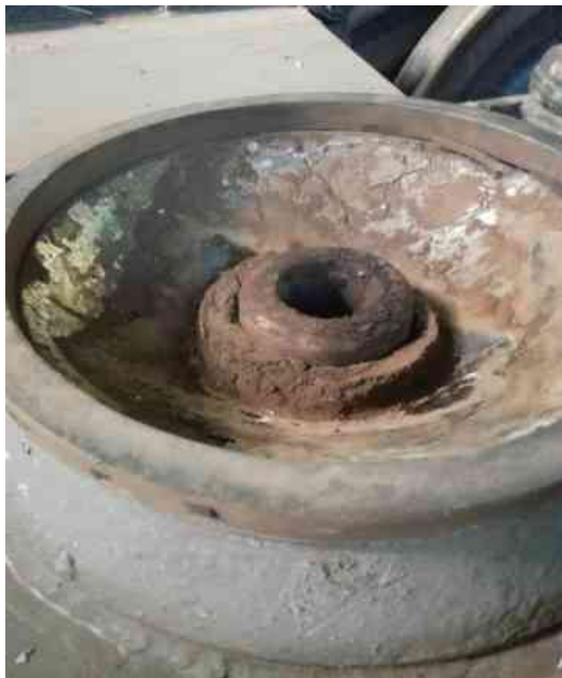
foto nr.3,4: starea plăcii de poliamidă aparținând boghiului cu roțile R 1÷4
