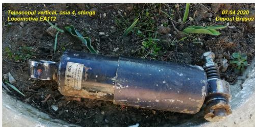
Foto 2 – Amortizorul vertical desprins, al osiei 4, partea stângă în sensul de mers
