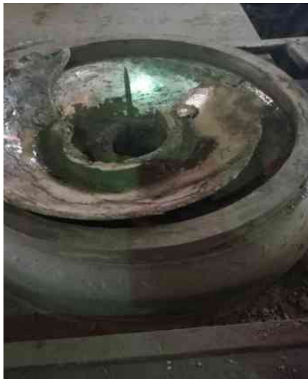
foto nr.3,4: starea plăcii de poliamidă aparținând boghiului cu roțile R 1÷4
