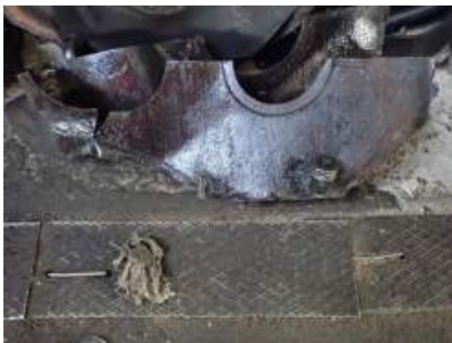
Foto nr.12 și nr.13 – semicarcasa inferioară a tobei de angrenaj
