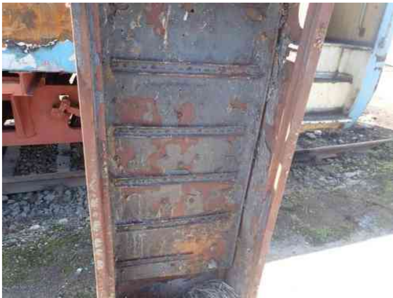
Foto nr.8—Carcasa în care se afla tabloul de siguranțe electrice și relee – scoasă din cabina automotorului
