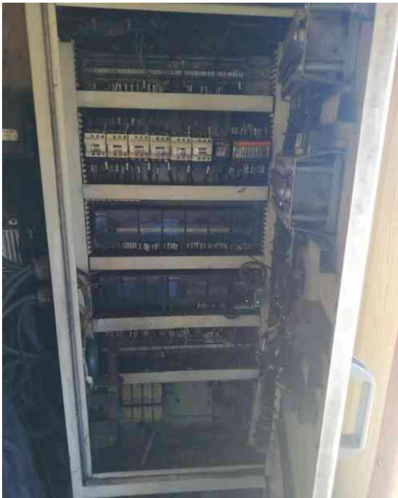
Foto nr.6–Pentru comparație - tabloul electric de siguranțe și relee de comandă de la automotorul nr.1019
