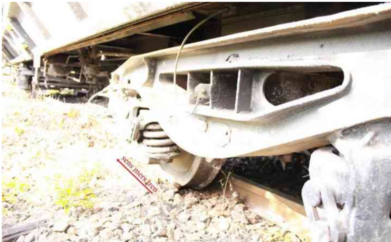
foto nr. 2: vagonul nr.81536666128-9 deraiat (roțile din partea stângă)
