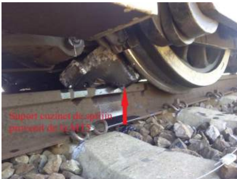
Foto nr.2 - semicarcasa cuzinetului de sprijin intercalat între roată și șină
