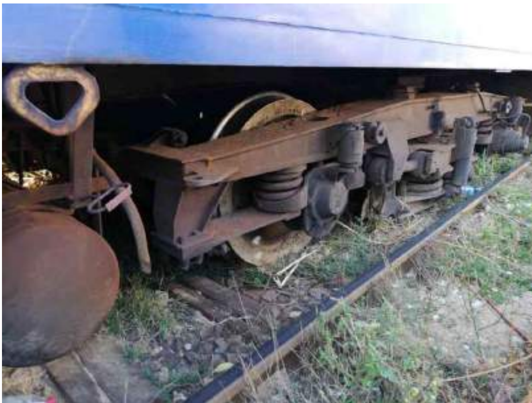
Foto nr.1 Vedere laterală a boghiului deraiat a vagonului nr.50532626112-0
