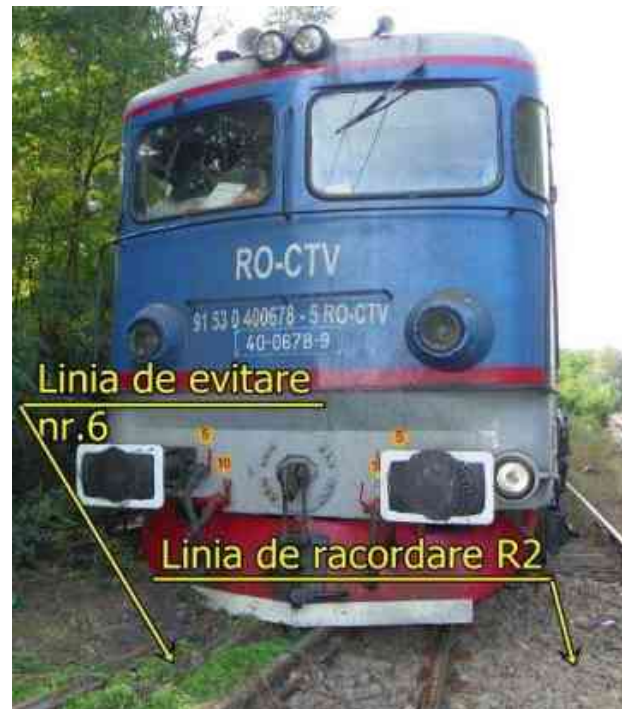
Foto nr.2 Locomotiva electrică EA 678 deraiată de primul boghiu în sensul de mers
