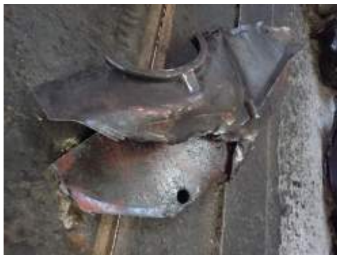
Foto nr.12 și nr.13 – semicarcasa inferioară a tobei de angrenaj
