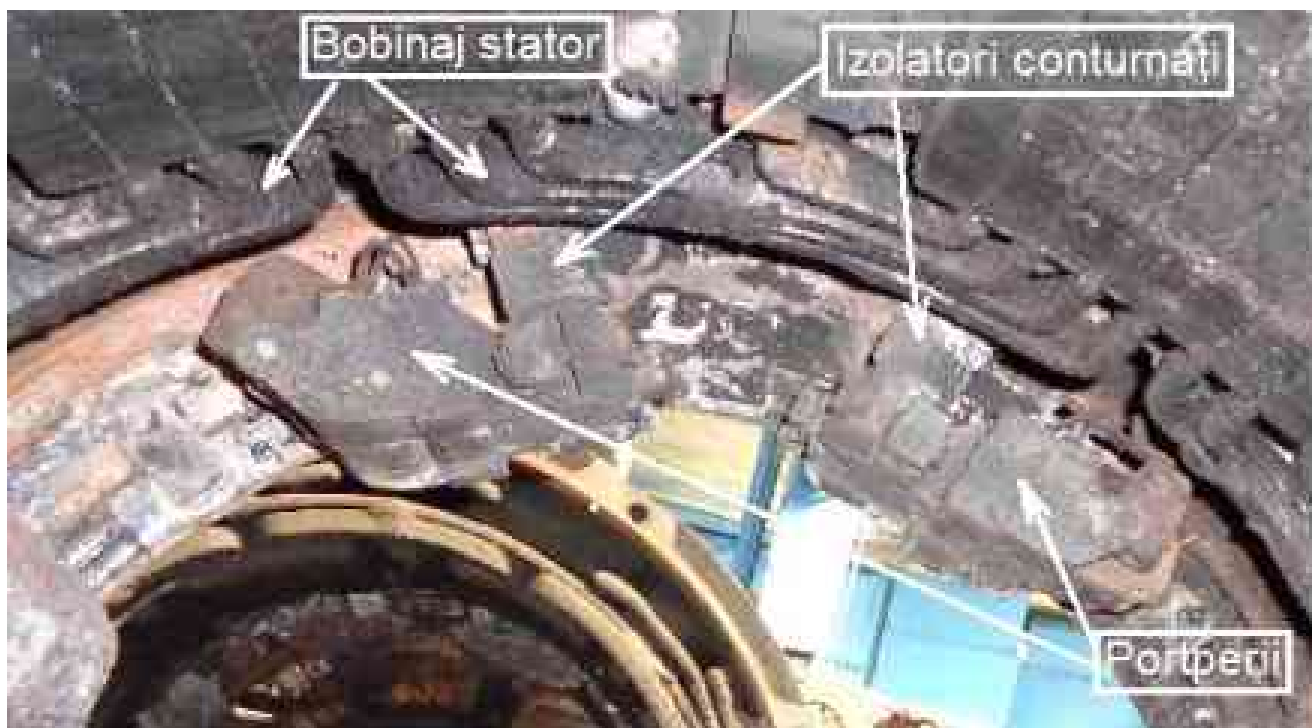
Foto.1. Izolatorii portperii conturnați, văzuți din interiorul motorului având statorul scos
