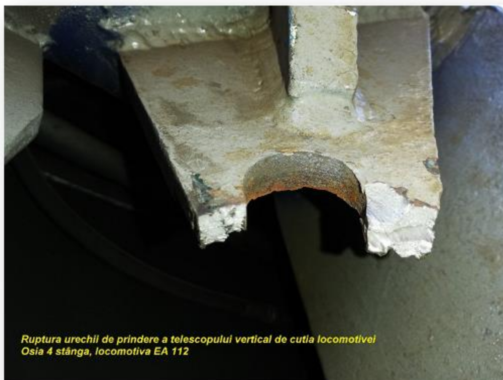
Foto 1 – Subansamblul de prindere a amortizorului vertical de pe cutia locomotivei, ruptă
