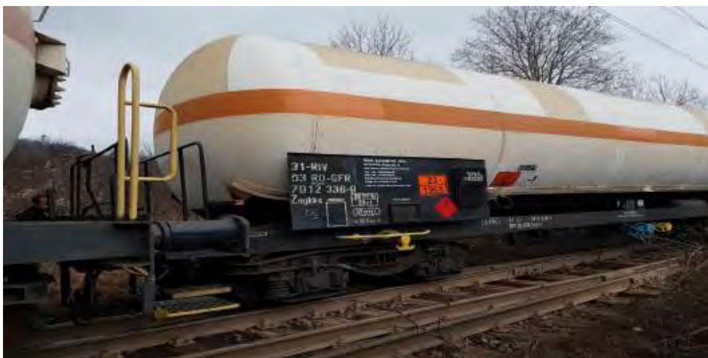
foto 1: poziția boghiului II al vagonului, după deraiere
