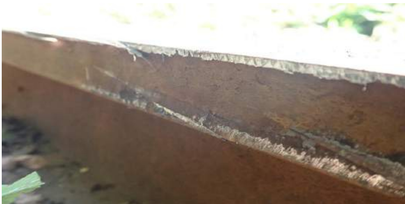
Fotografia nr.1 Detaliu cu urme de frecare specifice căderii roții (R1) la interiorul căii (șina de la firul interior al curbei/zona punctului 0)
