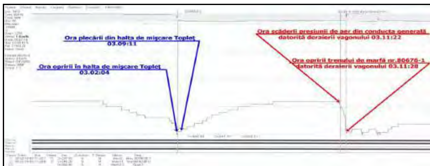
fig. 7 : diagrama IVMS – EA 1012 cu vitezele trenului înainte de producerea accidentului
