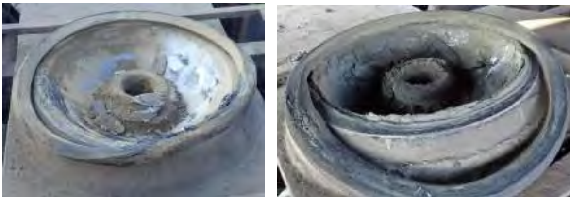
Foto nr.4 crapodinele inferioare cu plăcile de poliamidă deteriorate (în stânga: boghiul cu roțile 1÷4, în dreapta: boghiul cu roțile 5÷8)
