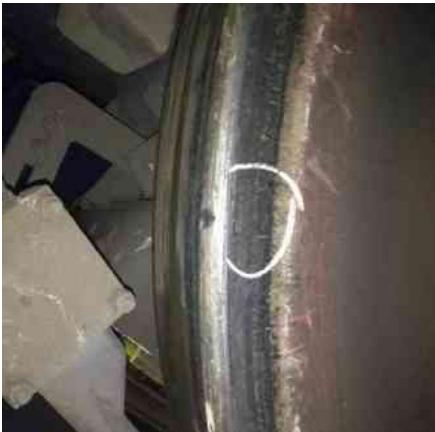
Foto nr.9 - știrbitură buză profil de rulare osia nr.1 roata din dreapta
