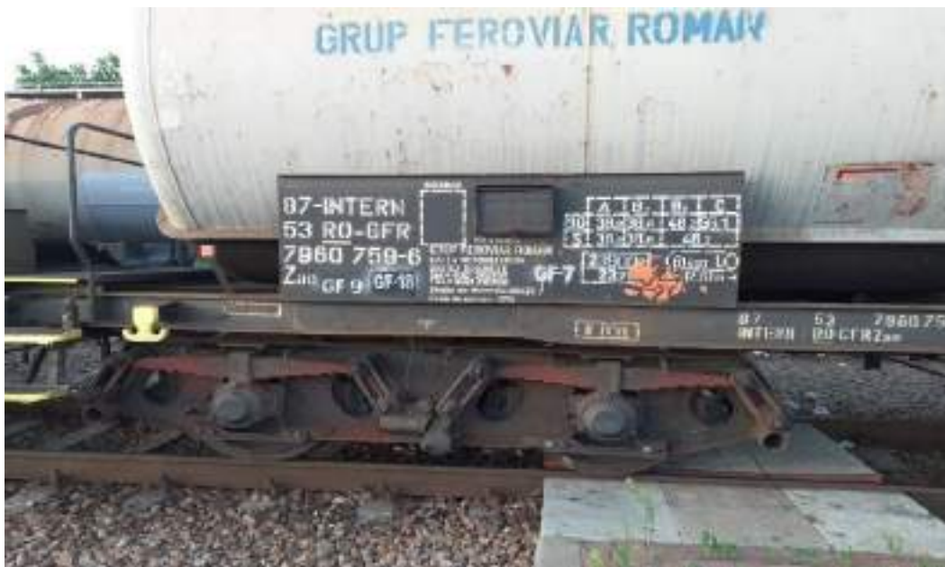
Fotografia nr. 8 - Roata nr.4 Lipsește un șurub de la interstada
