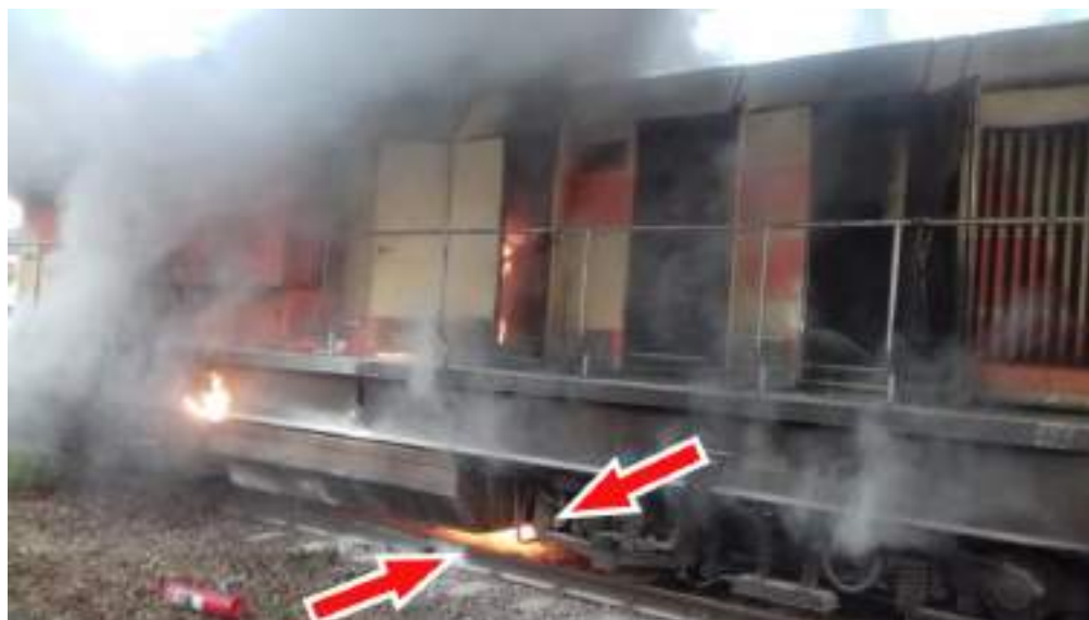
Imaginea 3 - flacări pe terasament sub rezervorul de motorină (imagini provenite de la martori oculari)
