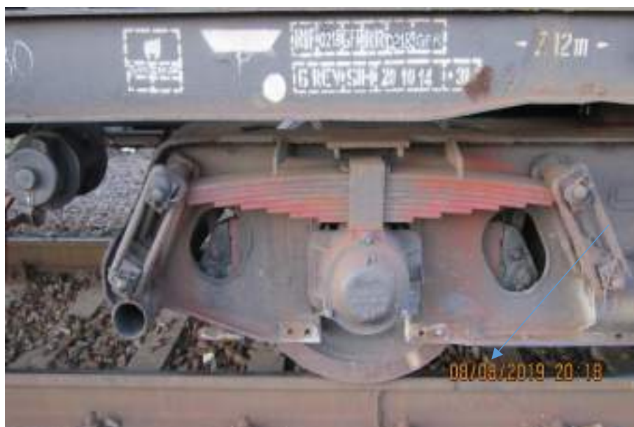
Fotografia nr. 6 – Roata nr. 6 de unde a căzut interstada
