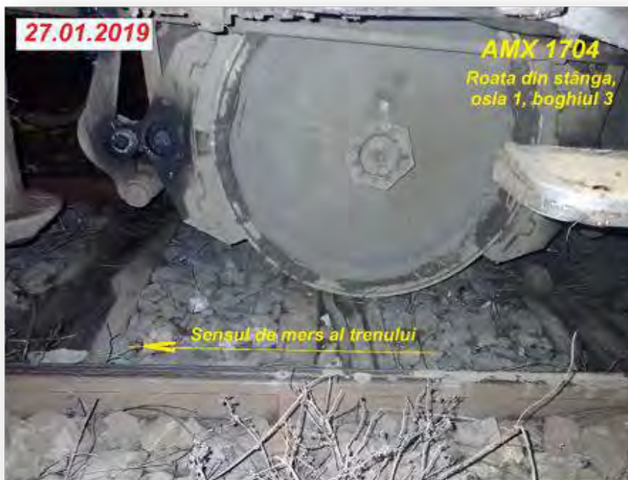
Foto nr.3 - Roata din stânga osiei nr.1, boghiul nr.3, în poziție deraiată în interiorul căii
