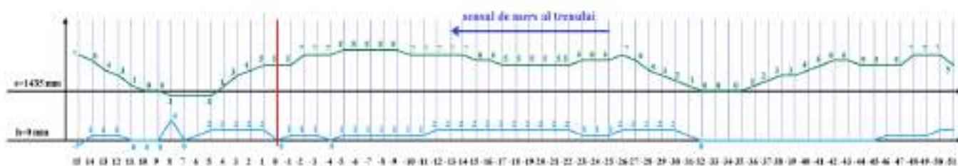
Figura nr.4 - diagrama cu valorile ecartamentului și nivelului transversal măsurate pe schimbătorul nr.10
