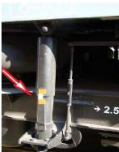
marcajul pentru înălțimea pernei - reglare corectă
