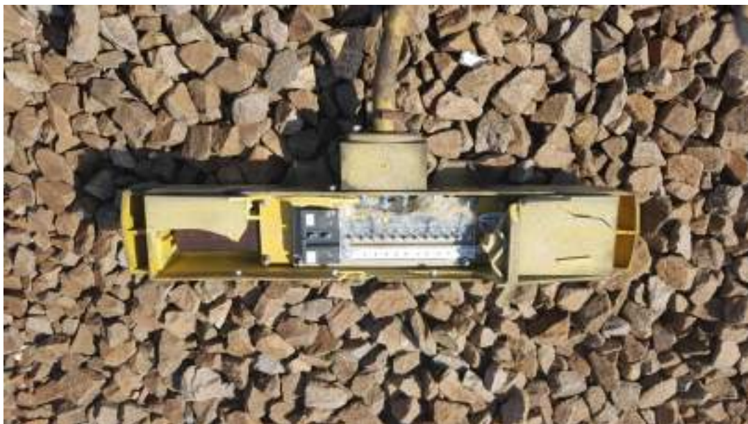
Fotografia nr. 3 – Inductorul deteriorat
