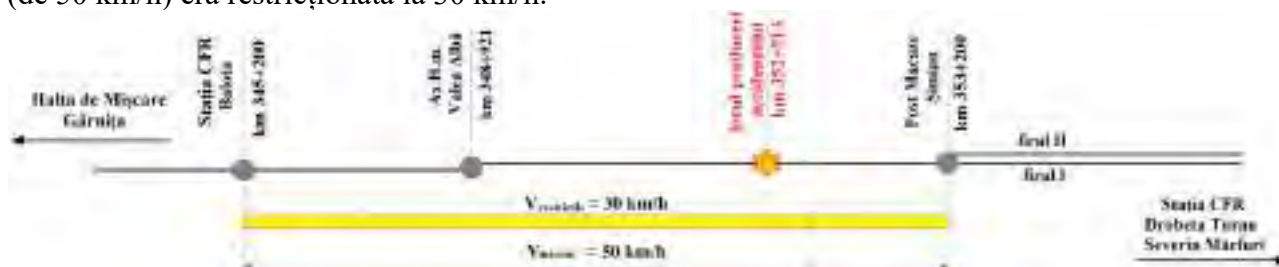
Figura nr.4 – Restricția de viteză existentă pe linia curentă dintre stația CFR Balota și stația CFR Drobeta Turnu Severin Mărfuri la data producerii deraierii
