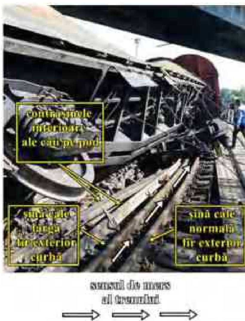
foto nr. 8 - vagonul al doilea deraiat și înclinat înspre interiorul curbei
