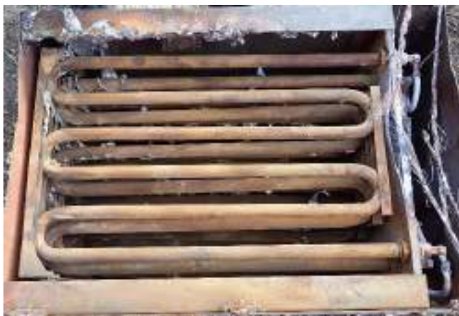
Foto nr.6 element de încălzire aflat în instalația de climatizare din partea cu frâna de mână
