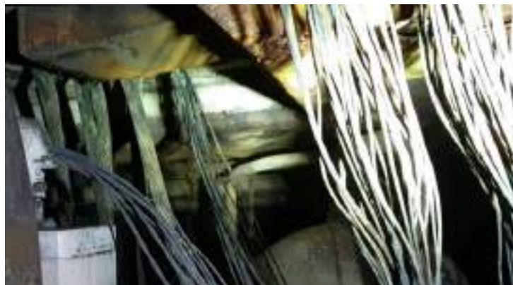
Imaginea 9 – cabluri electrice arse, aflate sub cabina de conducere în zona rezervorului
