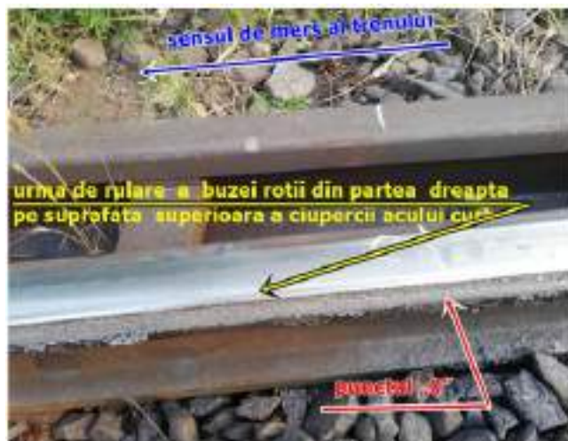
Foto nr.4 - urmele de deraiere pe acul curb al schimbătorului de cale nr.23
