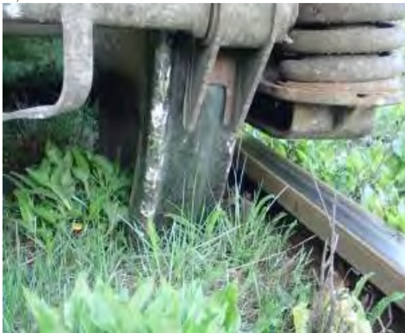
Fotografia nr. 7: Detaliu cu prima roată (R1)deraiată a trenului
