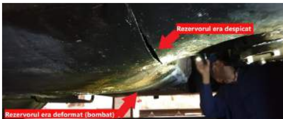
Imaginea 6 – rezervorul de motorină despicaț și deformat de o explozie în interiorul acestuia
