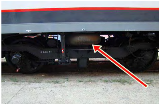
Suspensia secundară este asigurată cu perna de aer
