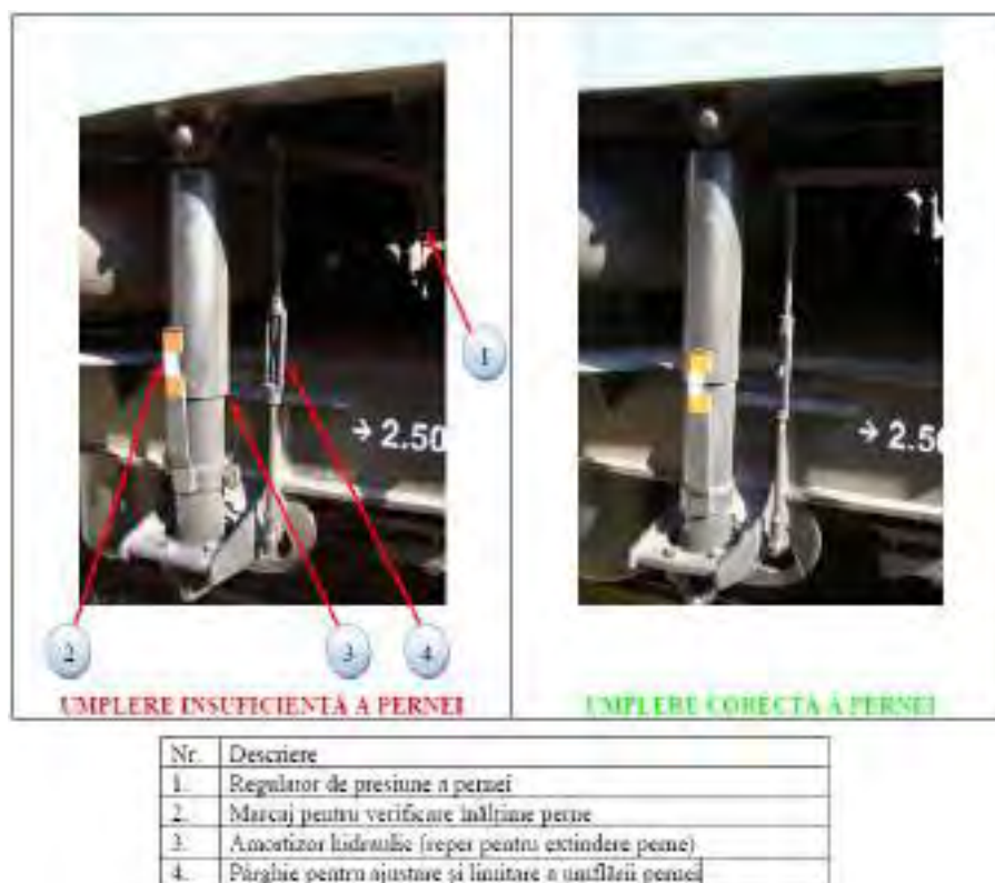
Indicatorul mecanic și reglajul înălțimii pernei de aer
