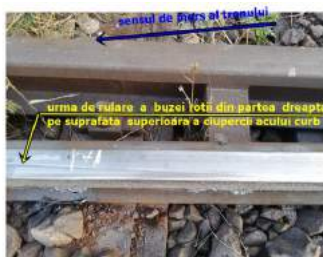
Foto nr.4 - urmele de deraiere pe acul curb al schimbătorului de cale nr.23
