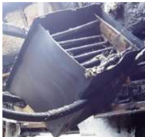
Foto nr.7 elementul de încălzire aflat în instalația de climatizare din partea din spate a vagonului
