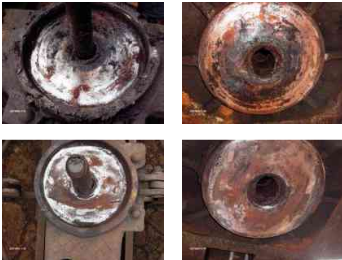
Figura 4 – Crapodinele de la primul vagon deraiat
