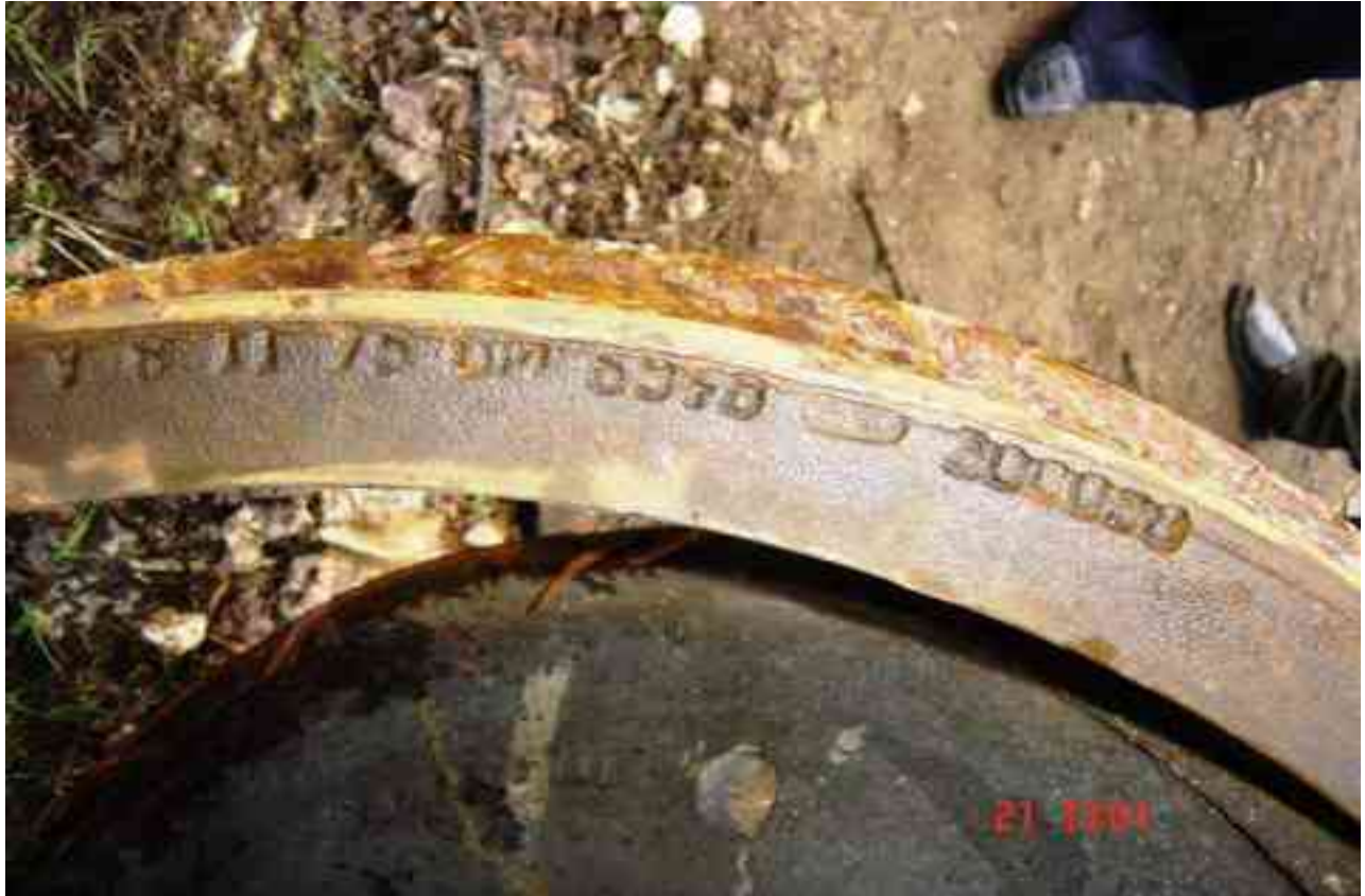
Figura 3 – marcajul bandajului roții nr. 5
