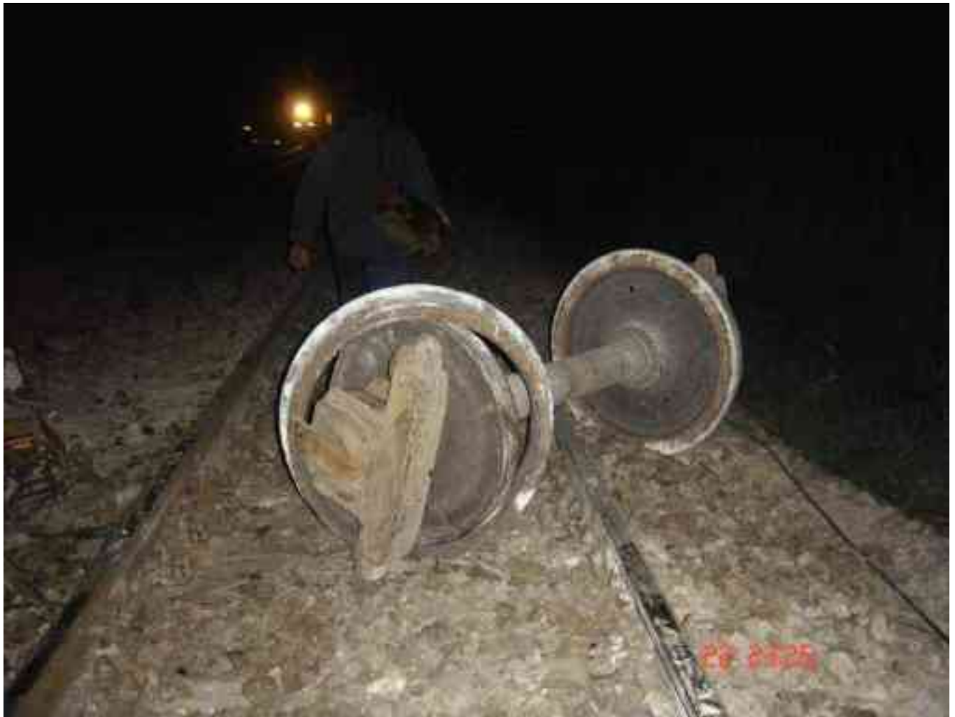
Figura 2 – roata nr. 5 a vagonului nr. 88536657717-3 cu bandajul deplasat de pe obadă
