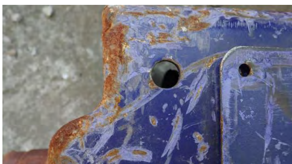
Foto 4 șurub retezat
