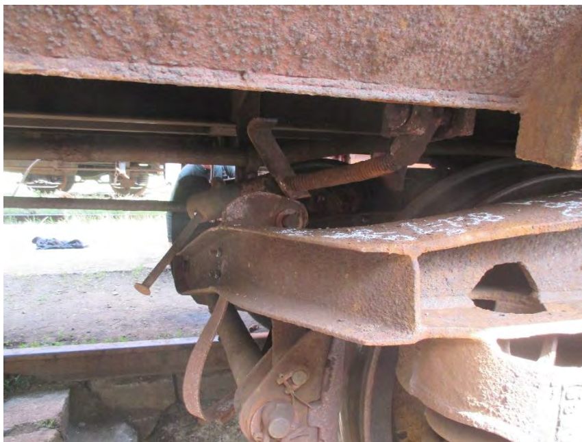
Figura nr.10 - poziția dispozitivul de asigurare a trapei din dreptul roții nr.6 imediat după deraiere
