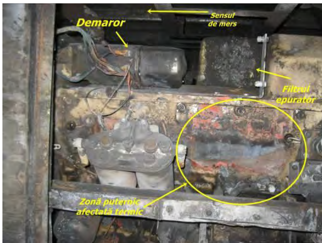
Foto nr.6 – poziționare demaror – filtrul epurator la motorul Diesel afectat
