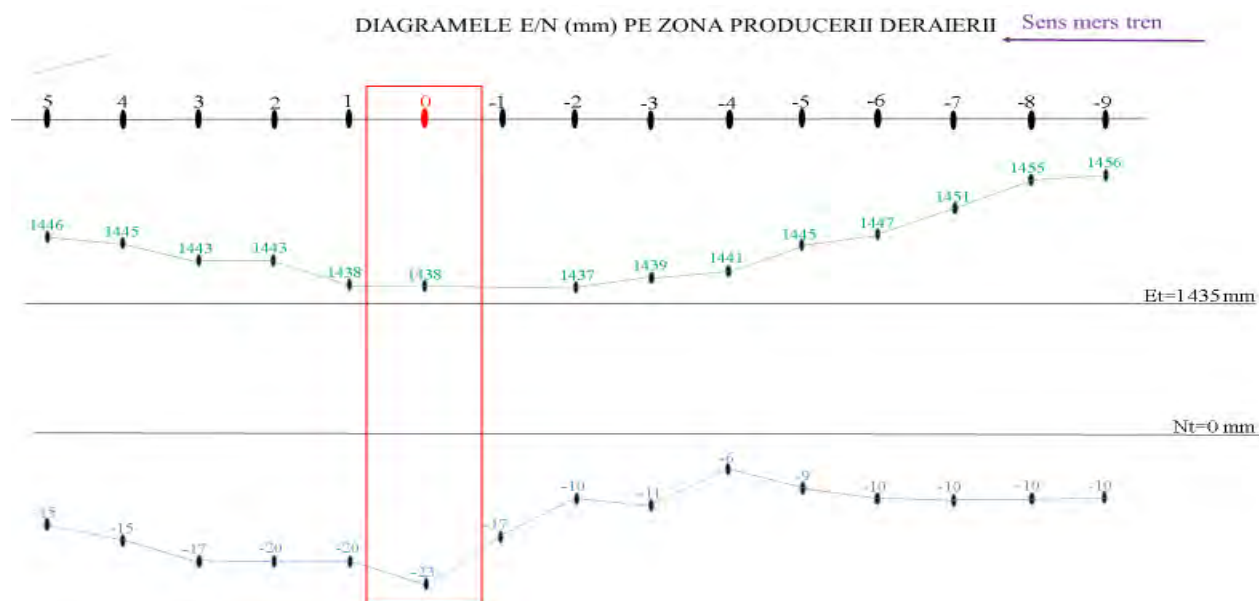
Figura nr.4 – digramele ecartamentului și nivelului transversal al căii
