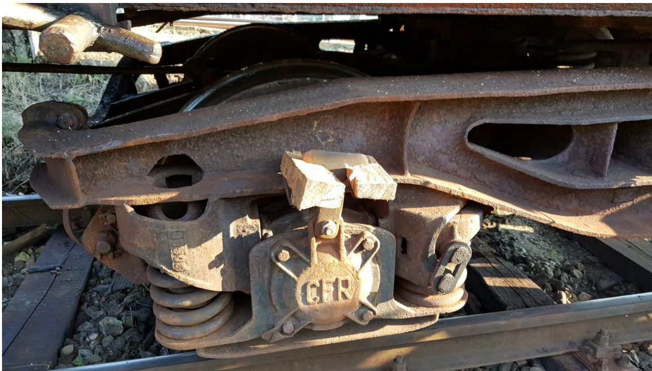
Foto nr.1 – urme de coroziune puternică a cadrului de boghiu
