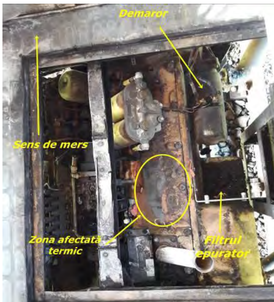
Foto nr.4 – motorul Diesel afectat
