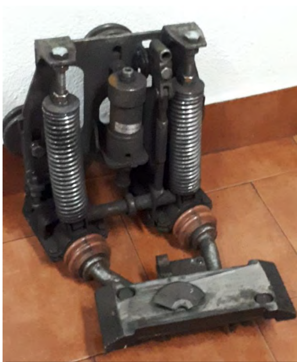
Figura 3. (sus) Captatorul avariat la REM 109, poză efectuată în stația Gara de Nord 2 înainte de demontarea acestuia
