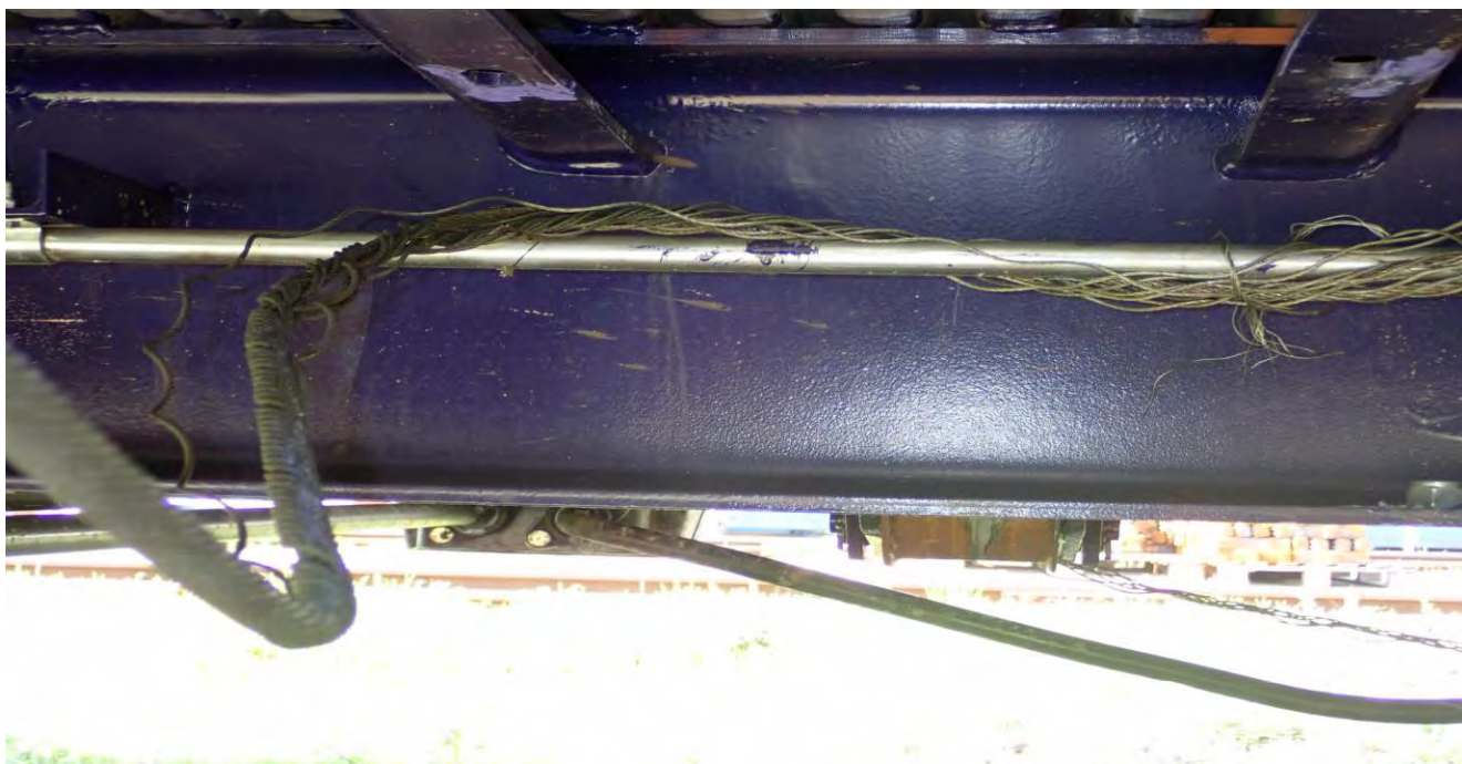
Foto 3: cablul oțelit rupt
