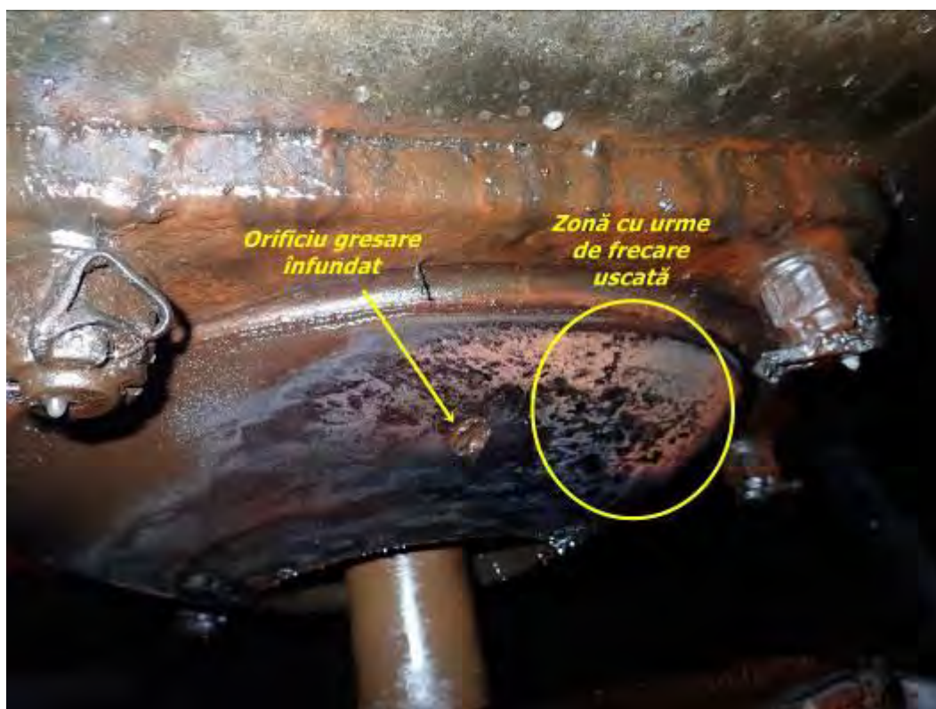
Foto nr.6 - Orificii pentru gresarea crapodinei înfundate, urme de frecare uscată și pete de rugină
