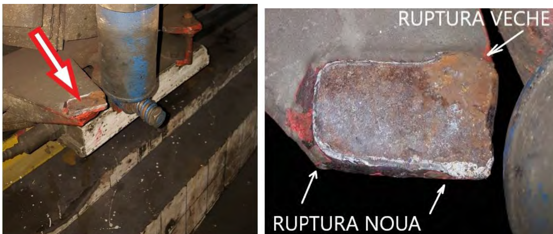
ruptură parțial veche la sudura de la suportul telescopului
