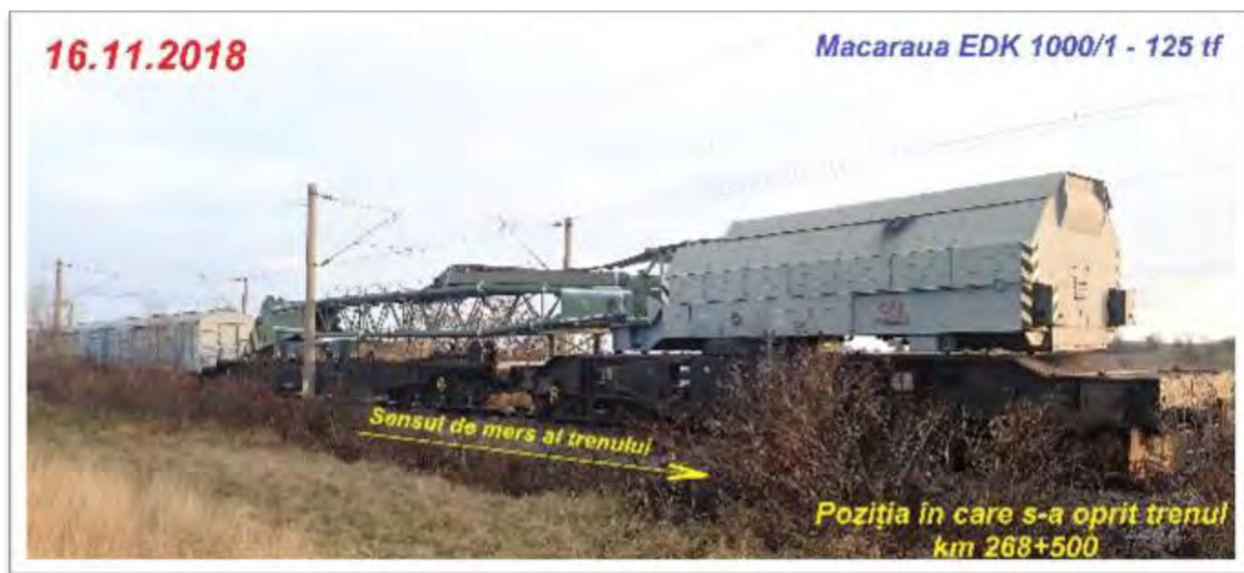
Foto nr.3 – Poziția în care s-a oprit trenul cu macaraua în stare deraiată, km 268+500
