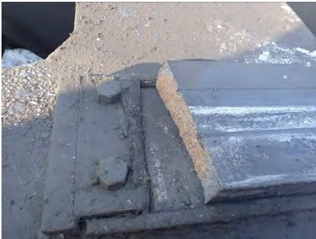
Foto nr.9 - Piatra de frezare de pe partea dreaptă în sensul de mers
