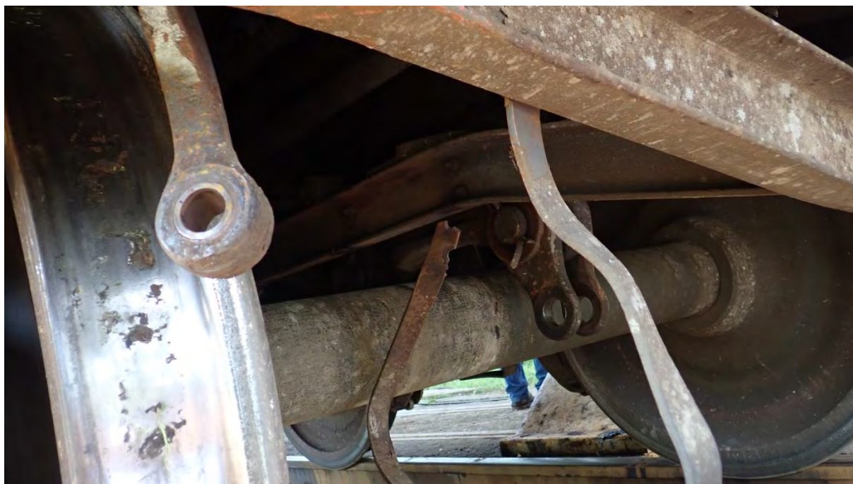
Fotografia nr.10 Etrier siguranță, rupt roata nr .7
