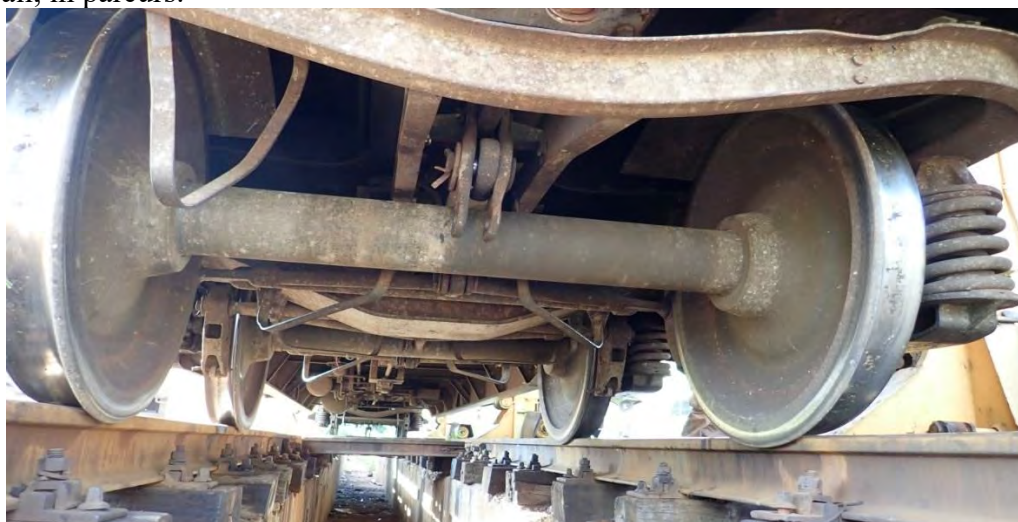
Fotografia nr.13.Etrier siguranță lipsa, roata nr. 8;
