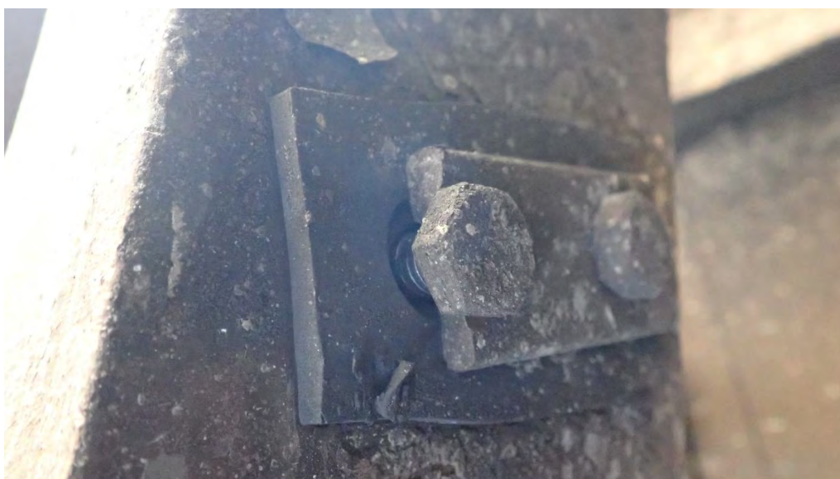
Fotografia nr.11. Etrier siguranță rupt roata nr .5
