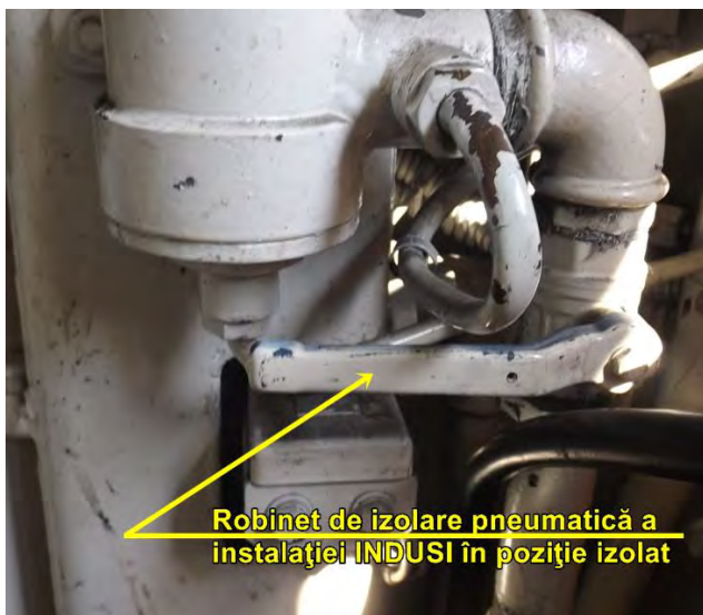
Foto nr.23 - robinet de izolare pneumatică izolat
