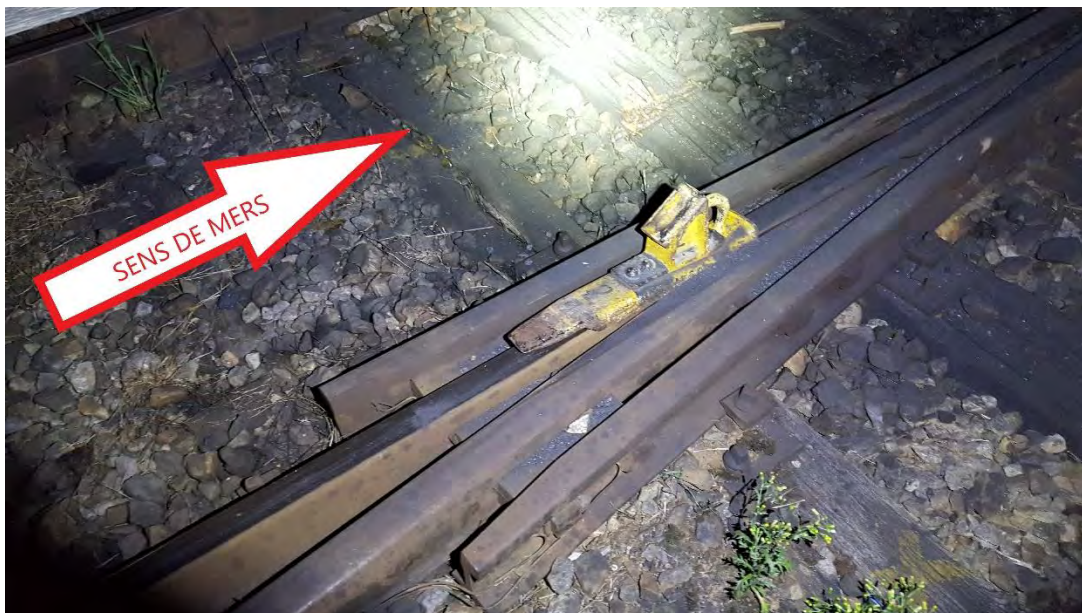
Imaginea 4 – locul producerii deraierii - poziția sabotului pe schimbătorul nr. 46
