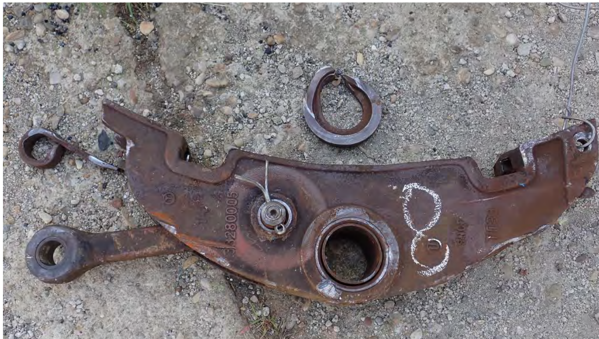
Fotografia nr.16. Port sabot și subansambluri, roata 8
