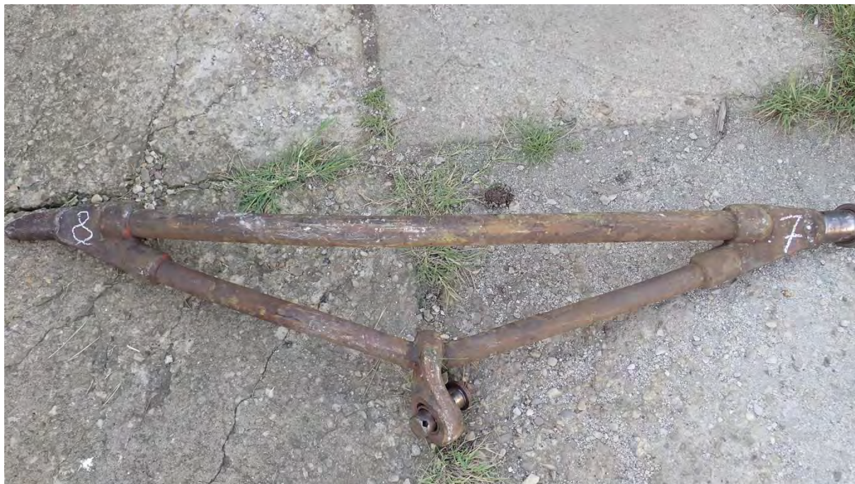
Fotografia nr.14.Axă triunghiulară osia 7-8 deformată
