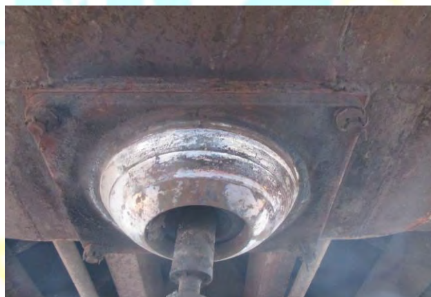
foto 14 – crapodina superioară corespunzătoare boghiului cu roțile 5-8
