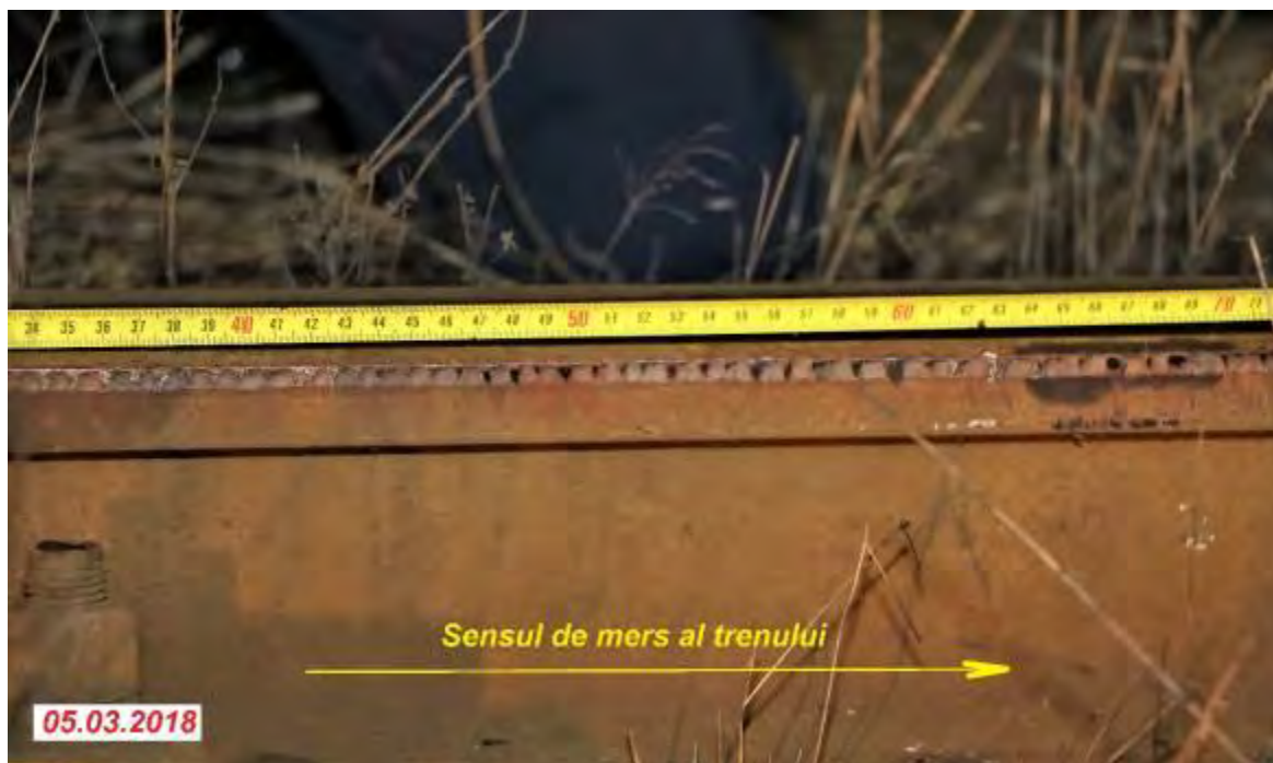
Foto nr.4 - detaliu - Fața laterală activă a ciupercii șinei de pe firul interior al curbei după deraiere
