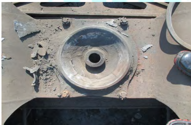
foto 13- crapodina inferioară corespunzătoare boghiului cu roțile nr.5÷8
