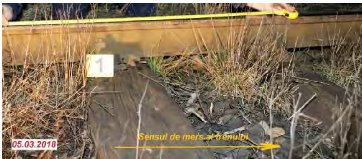
Foto nr.3 - Fața laterală activă a ciupercii șinei de pe firul interior al curbei după deraiere
