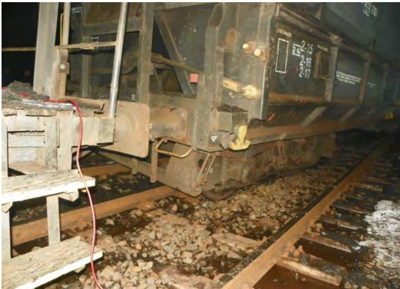
foto 1 - poziția vagonului nr. 4 din compunerea trenului după deraiere
