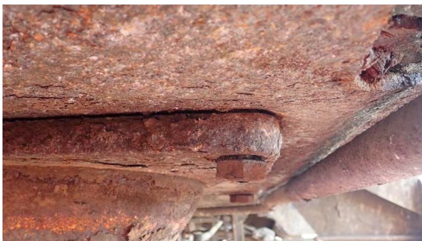
Imaginea nr. 19 - traversa crapodinei superioare deformată (înfundată)
