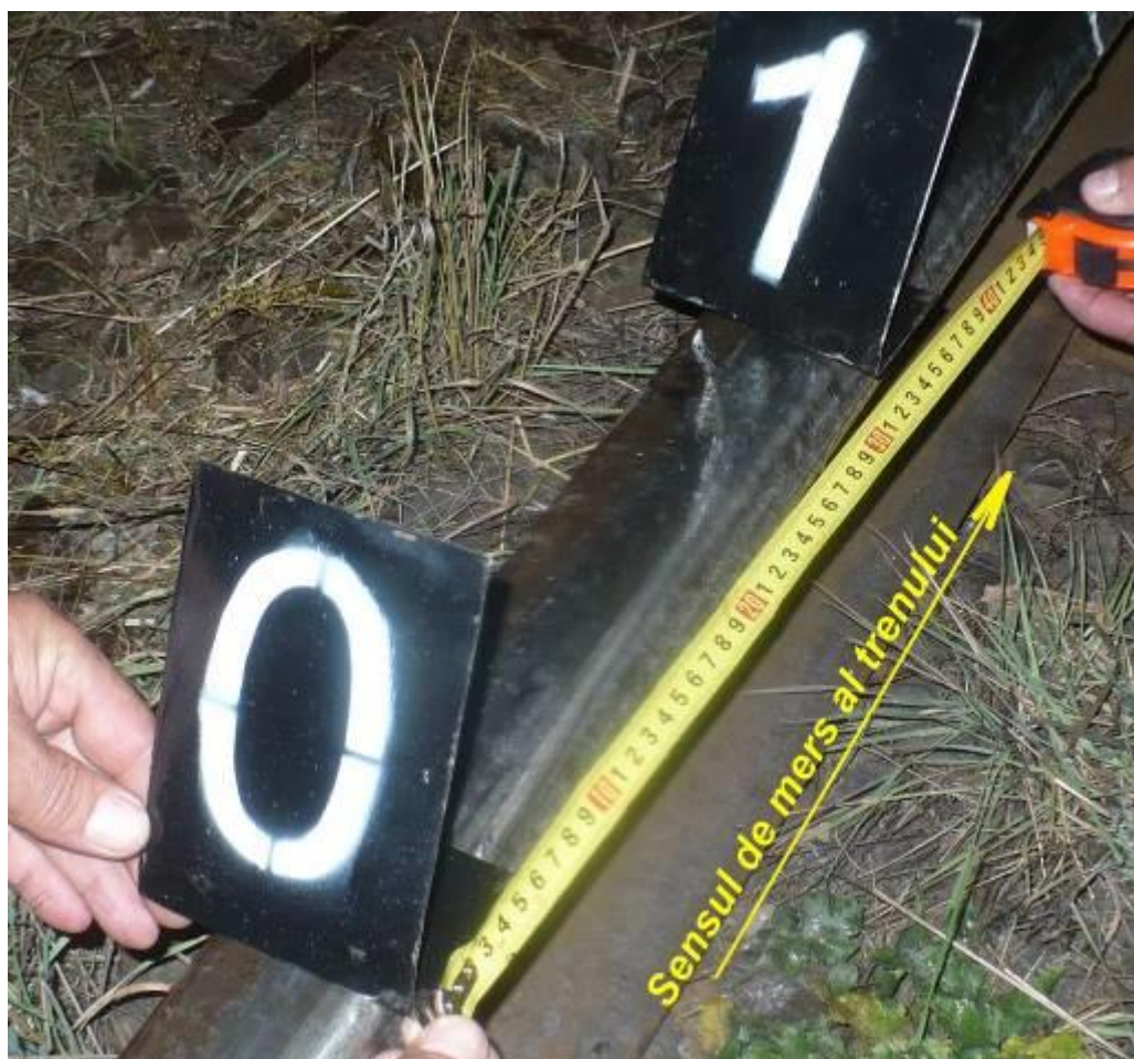
Foto nr.2 - Urma de deraiere, punctele de escaladare („0”) și de cădere („1”)
