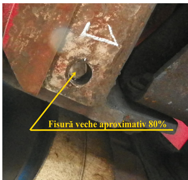
Fig.6 Parte filetată a șurubului rămasă în locașul suportului suspensiei
