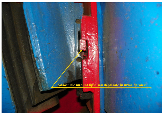
Foto 5: Adaosuri metalast roată osia 6 partea dreaptă sens de mers – față
