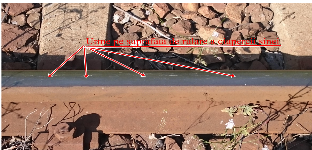
Foto 4. Urme pe suprafața de rulare a ciupercii șinei
