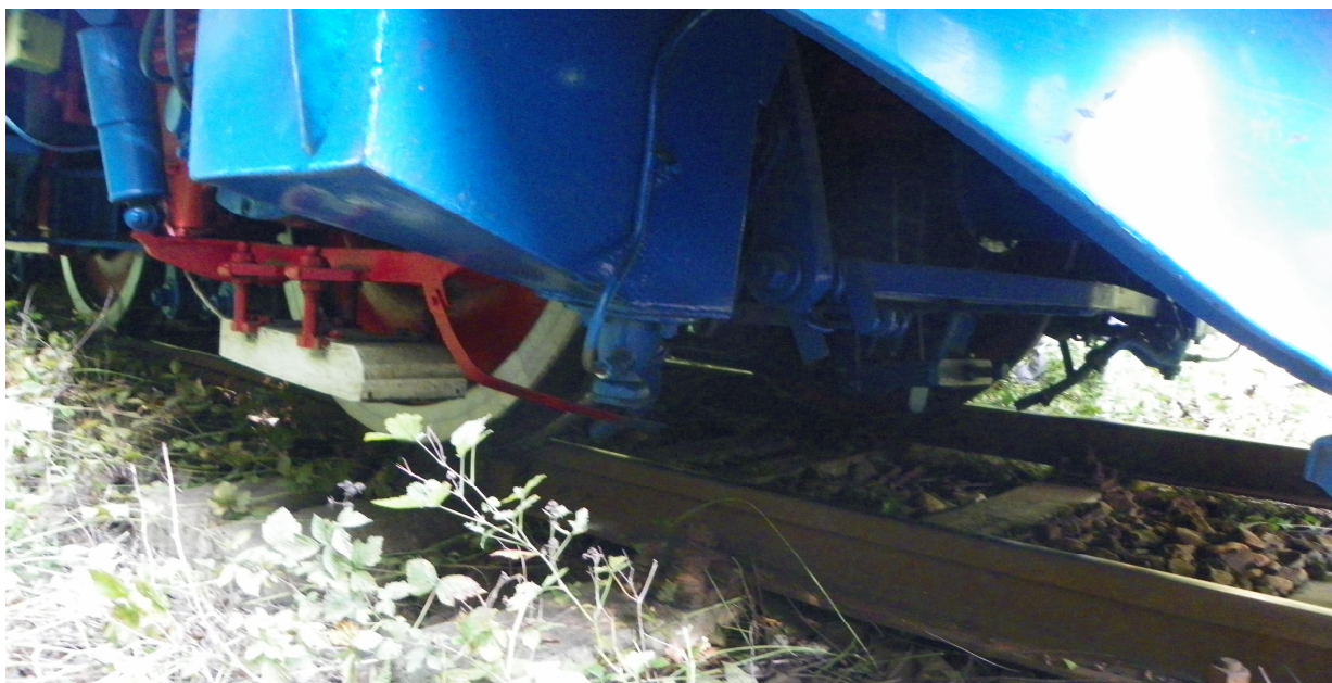
Foto 1. Poziția locomotivei EA 130 după deraiere
