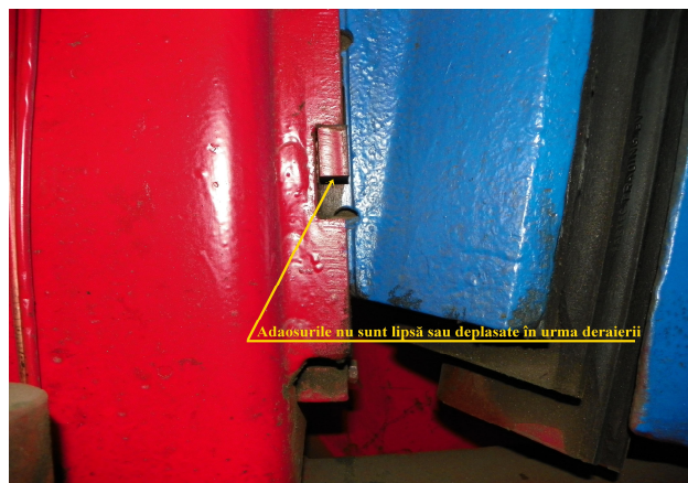
Foto 6: Adaosuri metalast roată osia 6 partea dreaptă sens de mers – spate
