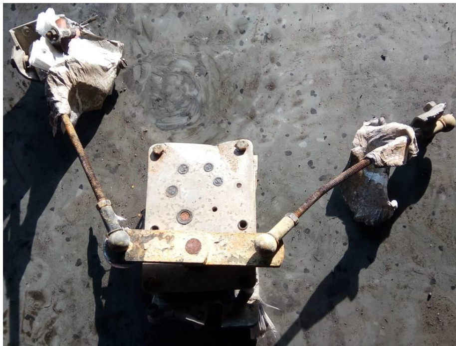
Fig. 5 – Servomotor acționare clapeti aer afectat termic
