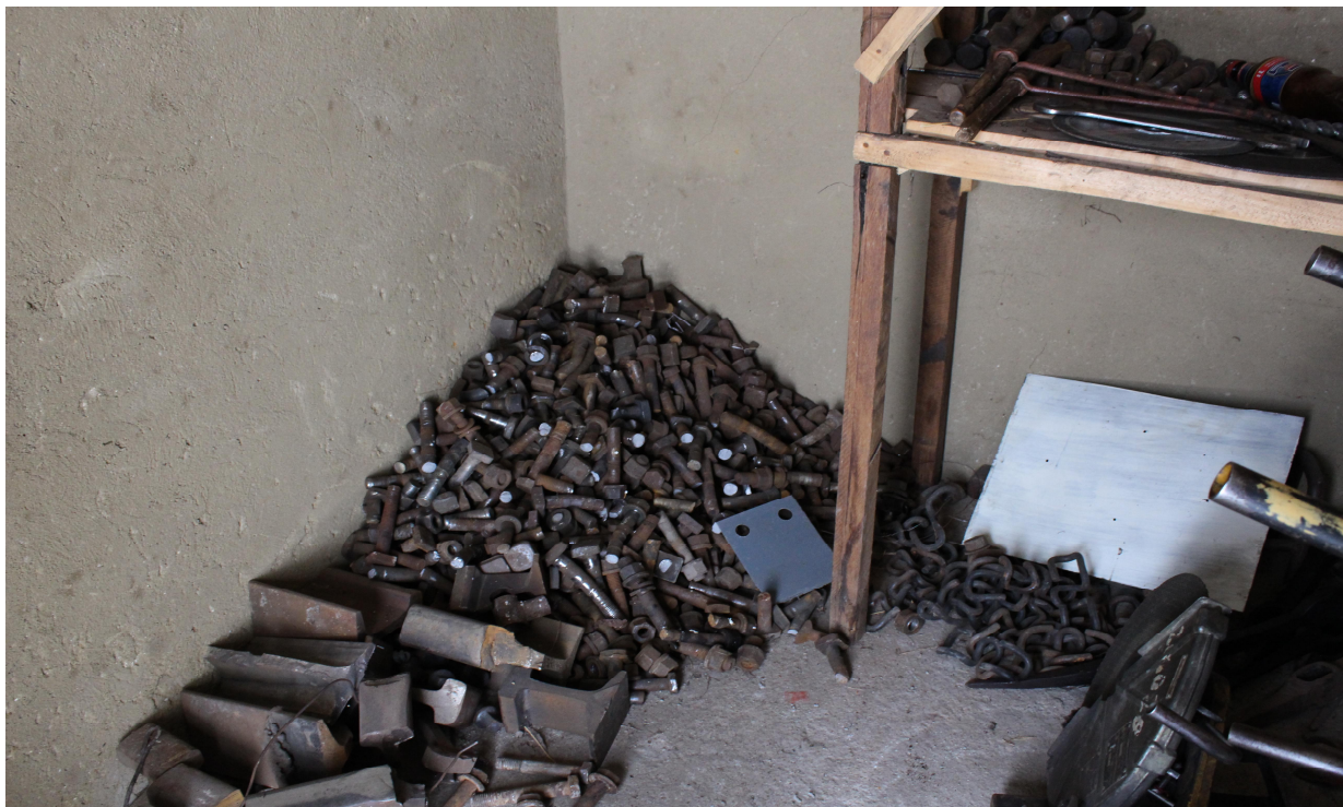
Foto 5- șuruburi orizontale secționate
