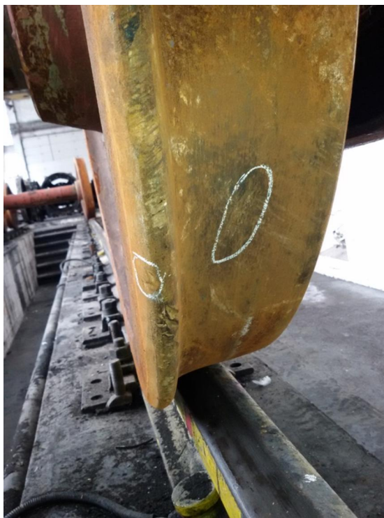
Foto 19 - urmele rezultate din interacțiunea roții cu cuponașul
