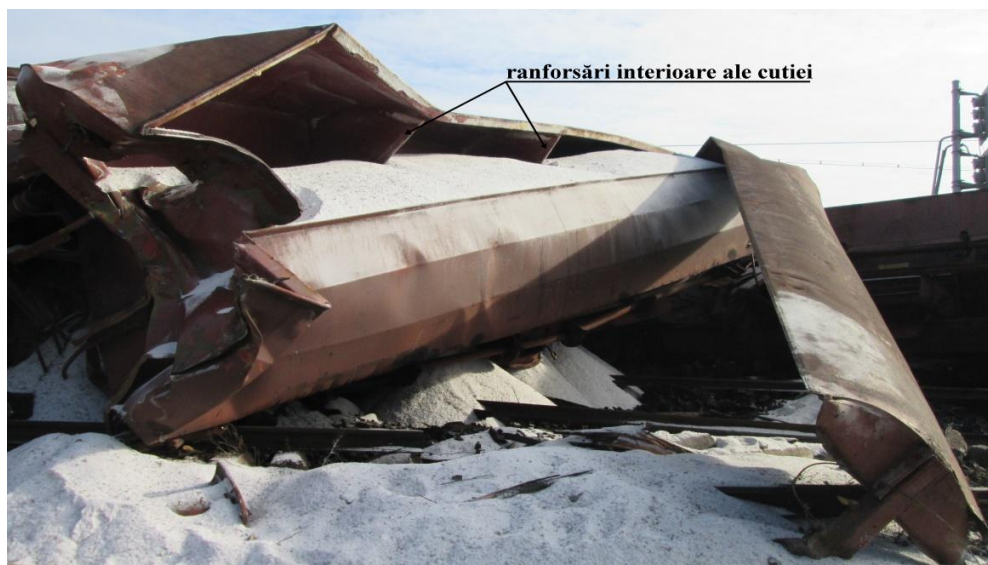
Foto 17 -încărcătura și modul de distribuire a încărcăturii
