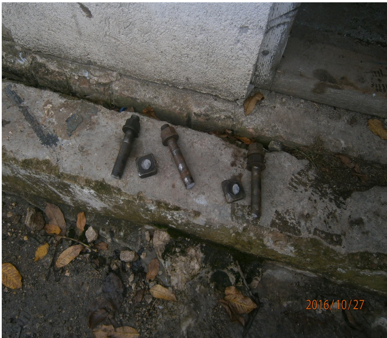
Foto 1– buloanele orizontale secționate
