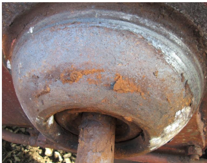
Foto12- crapodină superioară fără urme de frecare metal pe metal
