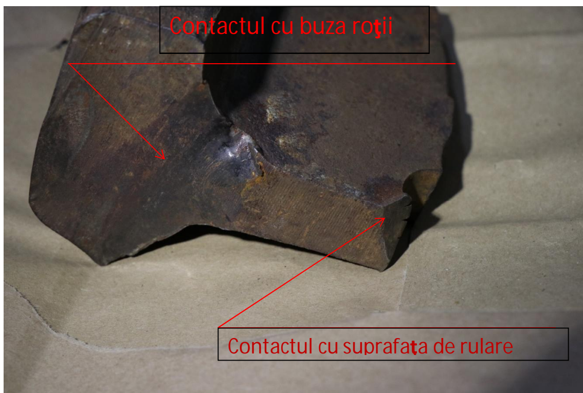
Foto 18- urma rezultată de la contactul cu buza roții cât și urma rezultată de la contactul cu suprafața de rulare a roții.
