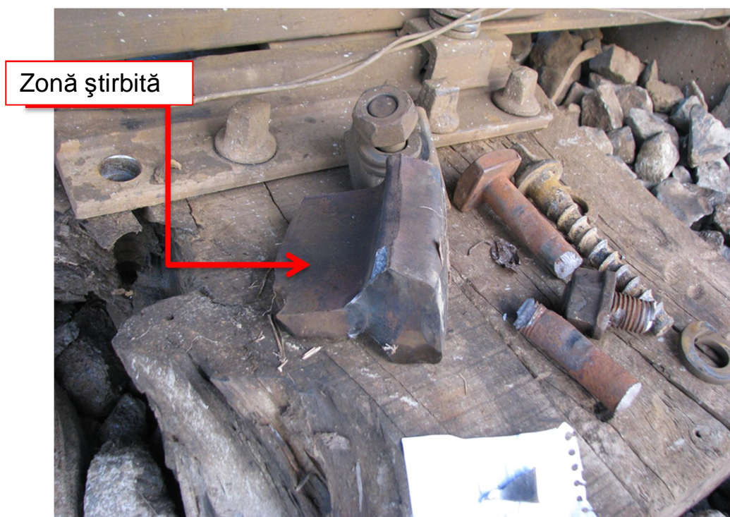
FOTO 7 - cuponaș de șină care prezenta o zonă știrbită cu aspect de ruptură nouă
