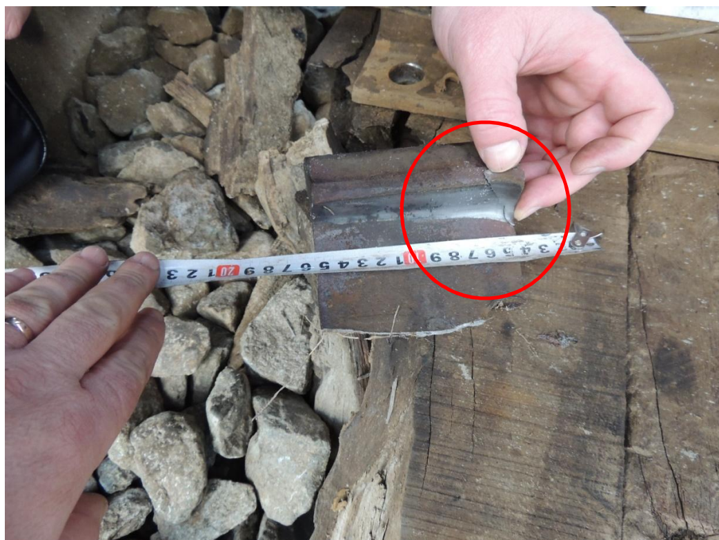
Foto 8 - așchia metalică poziționată pe cuponașul cu lungime de 110 mm
