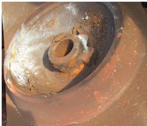
Foto13- crapodină inferioară fără urme de frecare metal pe metal
