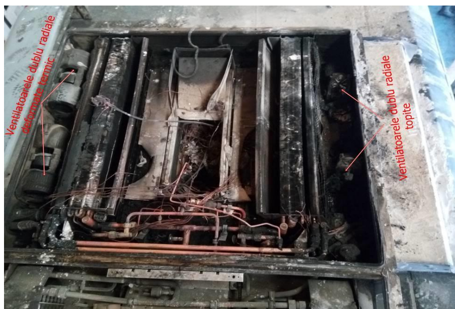
Fig. 4 – Ventilatoarele dublu radiale ale automotorului AM Desiro 2114
