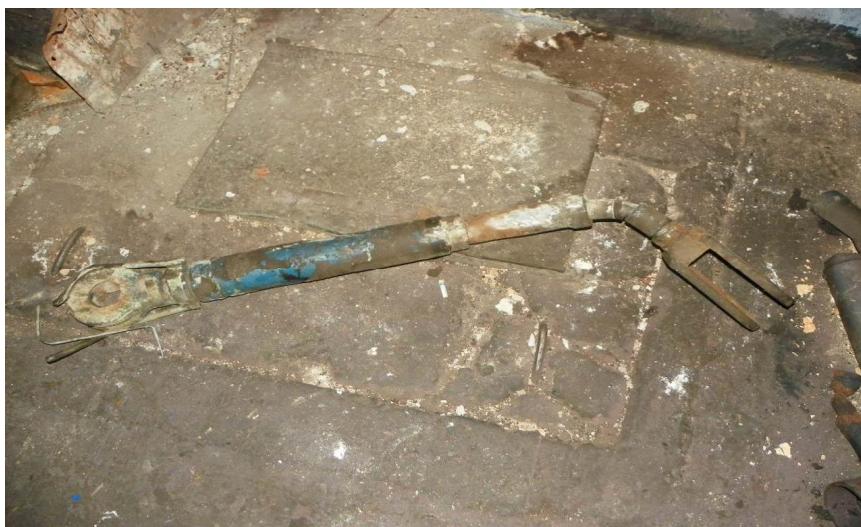
Fig.1. Regulatorul automat de timonerie tip RL2-350 de la osia nr.6 a locomotivei electrice EA 314
