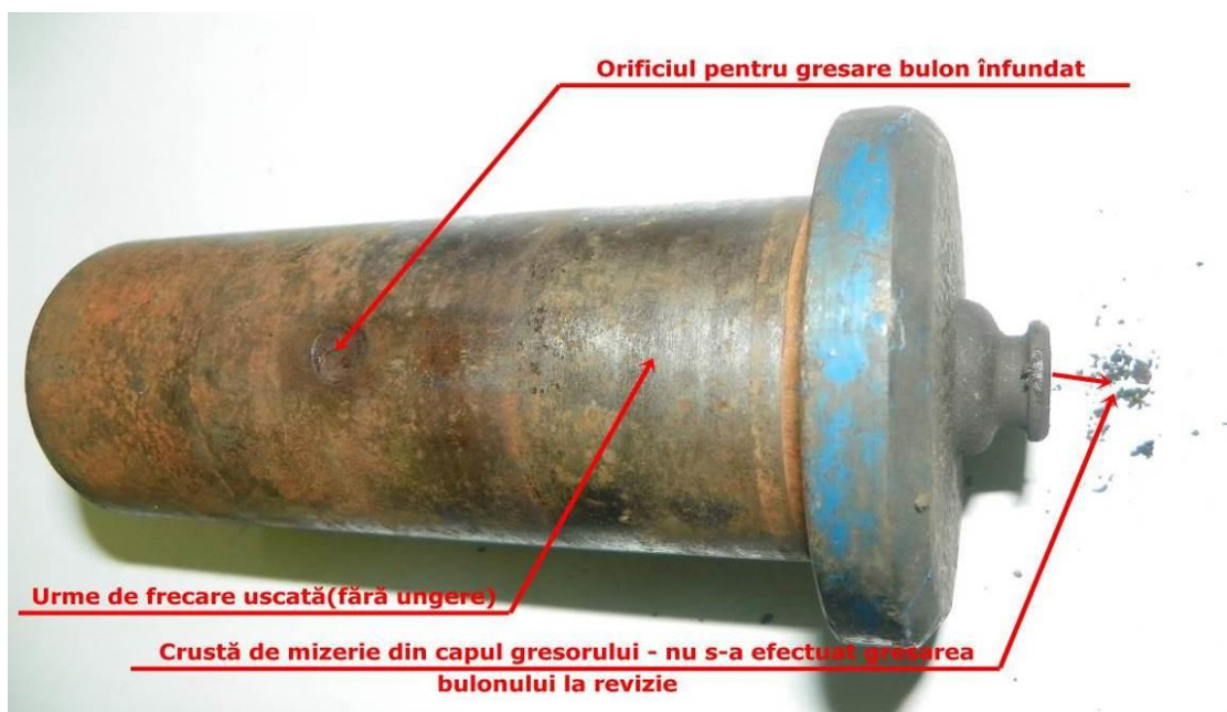
Fig.11. Bulonul de fixare a urechii corpului regulatorului automat de timonerie tip RL2-350 de pârgă timoneriei de frână – lipsă ungere (gresare).
