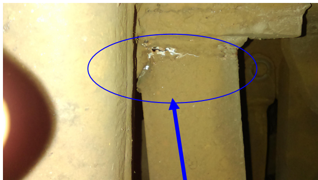
Braț suport nr.2 de fixare inductor- fisurat și îndoit în sens invers sensului de mers
