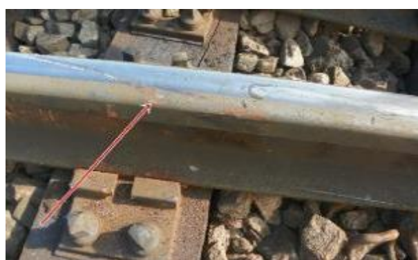
Foto 10 – locul căderii roții partea dreaptă în sensul de mers a osiei nr.2
