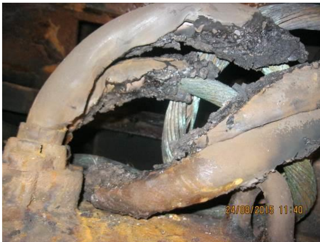
Foto nr.4 – cablurile de alimentare afectate termic
