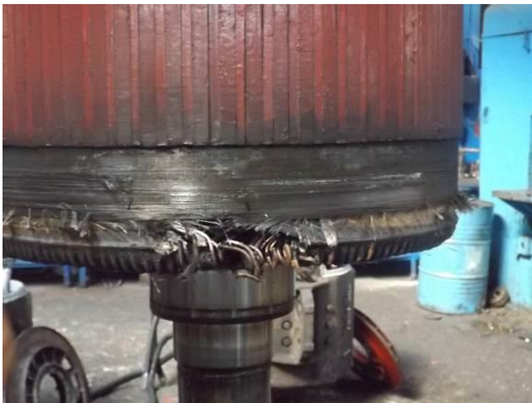
Foto nr.3 – spirele bobinajului rotoric al motorului de tracțiune nr.4
