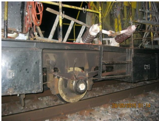
Fig. nr.2: Urmările coliziunii la DP052 Fig. nr.3: Drezina pantograf DP 052 avariata
