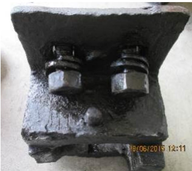
Caseta de înzăvorâre fixător de mijloc, montată pe contraacul drept (înzăvorâre ac curb) Foto nr.40
