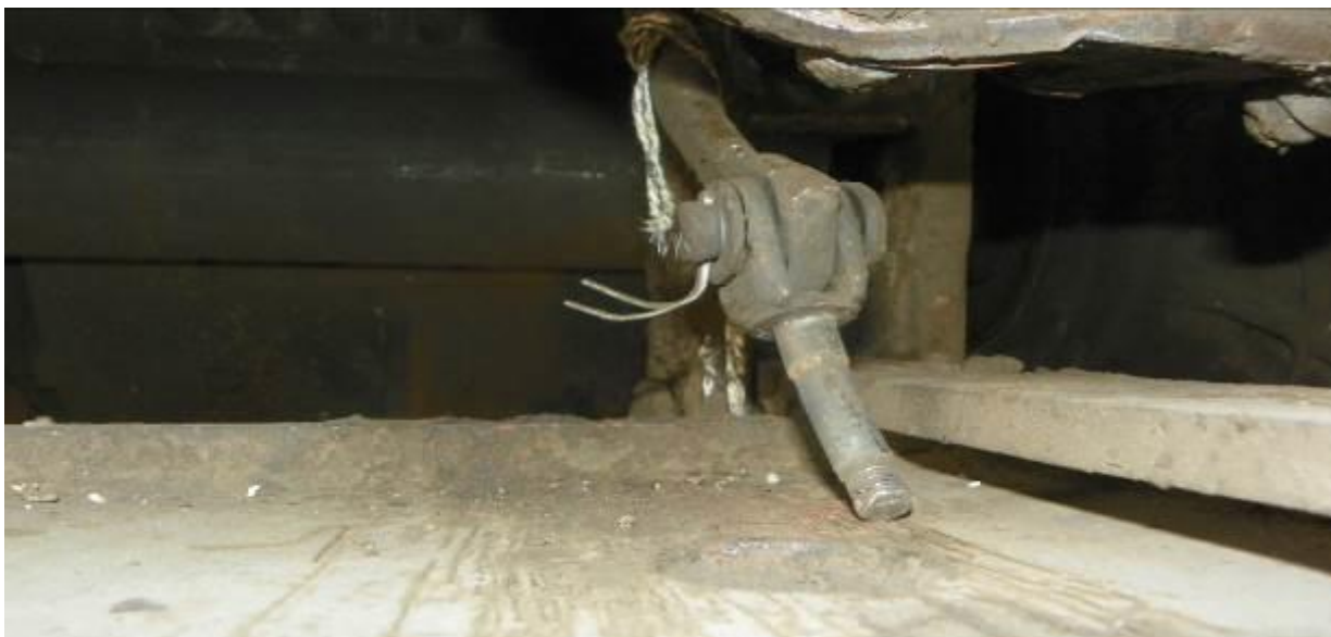
Fig. 6 Bara de cuplare a carterului regulatorului.
