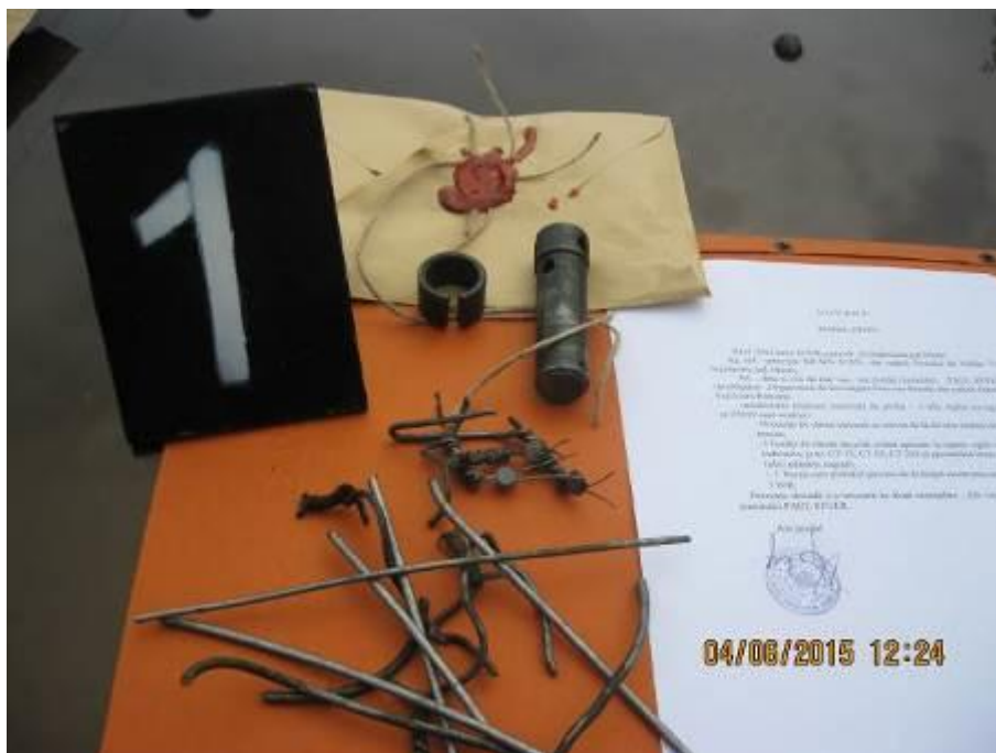
Foto nr.25 – Bolțul, bucașa și sârmele găsite în zona schimbătorului de cale nr.7
