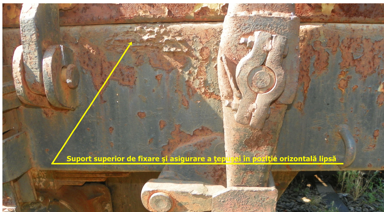
Fig. 5 Suport superior de fixare și asigurare a țepușei în poziție orizontală – lipsă
