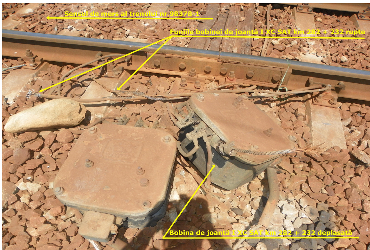
Fig. 3 Bobina de joantă I XC SAT 282 + 232 deplasată cu funiile de oțel rupte
