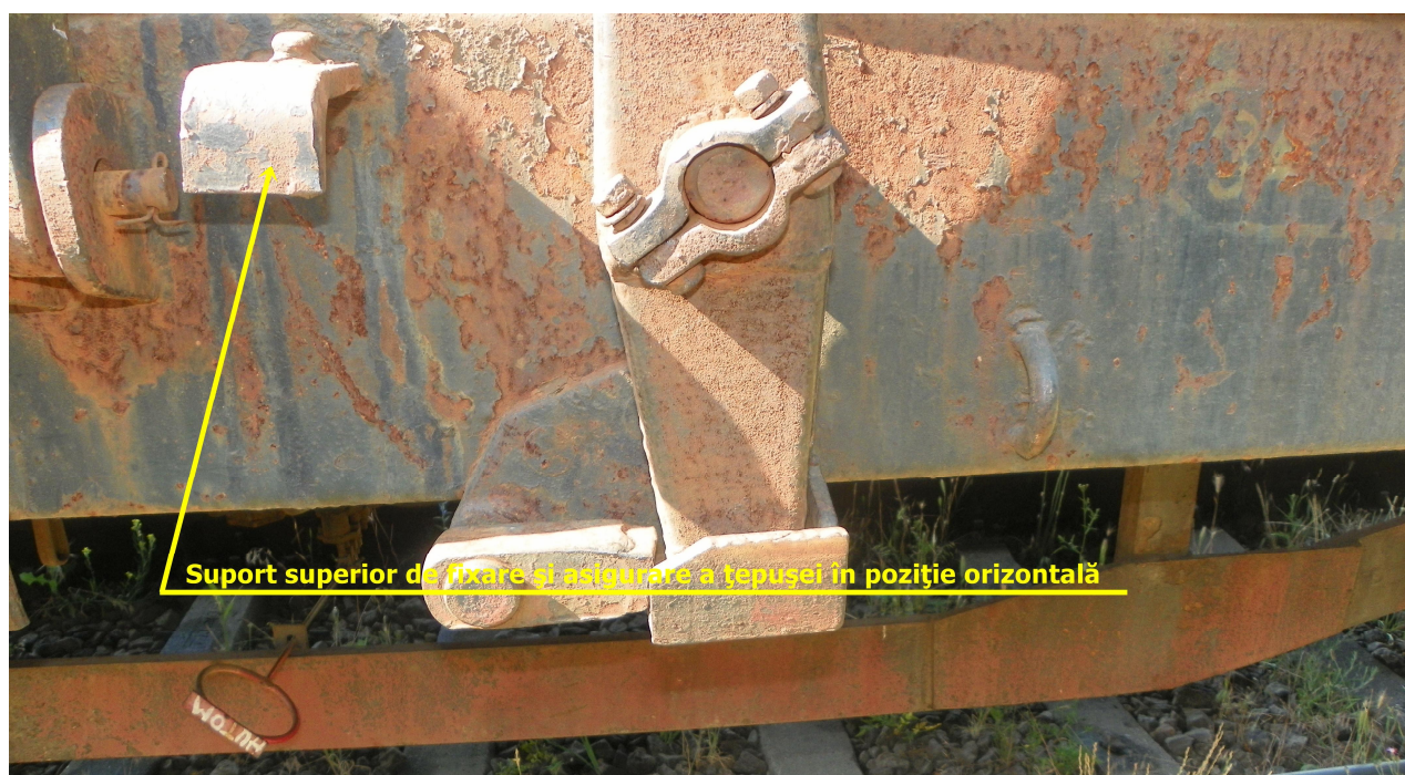
Fig. 6 Suport superior de fixare și asigurare a țepușei în poziție orizontală
