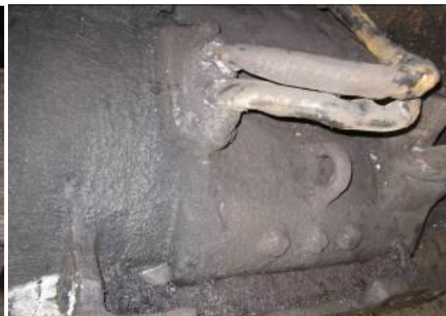
Fig.7 – Urme de ulei pe carcasa motorului de tracțiune și a sitei ventilatorului
