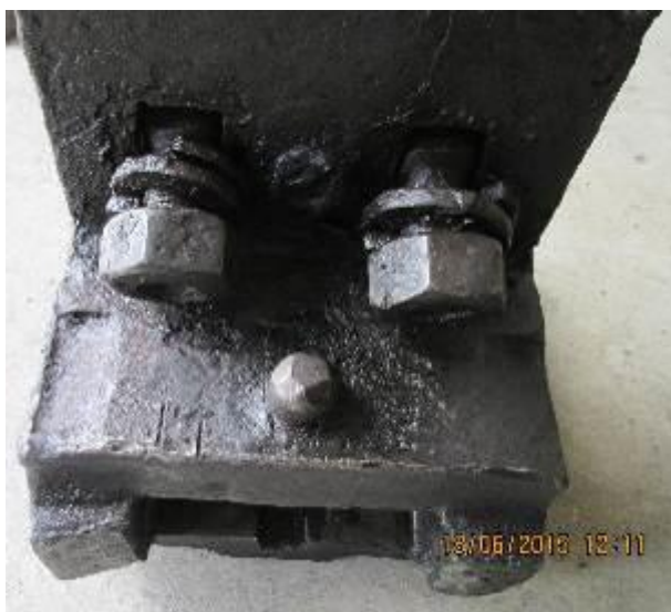
Caseta de înzăvorâre fixător de vârf, montată pe contraacul curb (înzăvorâre ac drept) Foto nr.37
