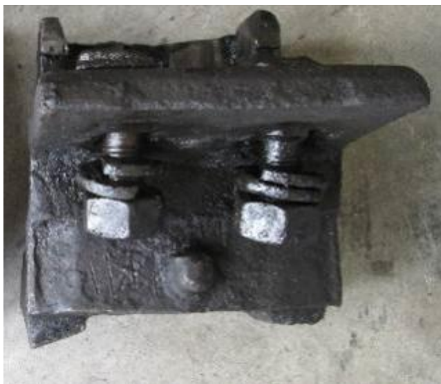
Caseta de înzăvorâre fixător de mijloc, montată pe contraacul curb (înzăvorâre ac drept) Foto nr.39
