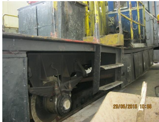
Fig. nr.2: Urmările coliziunii la DP052 Fig. nr.3: Drezina pantograf DP 052 avariata
