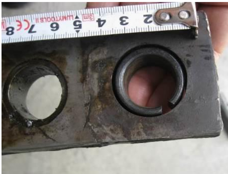
Foto nr.36 - gaura din fixatorul de vârf
