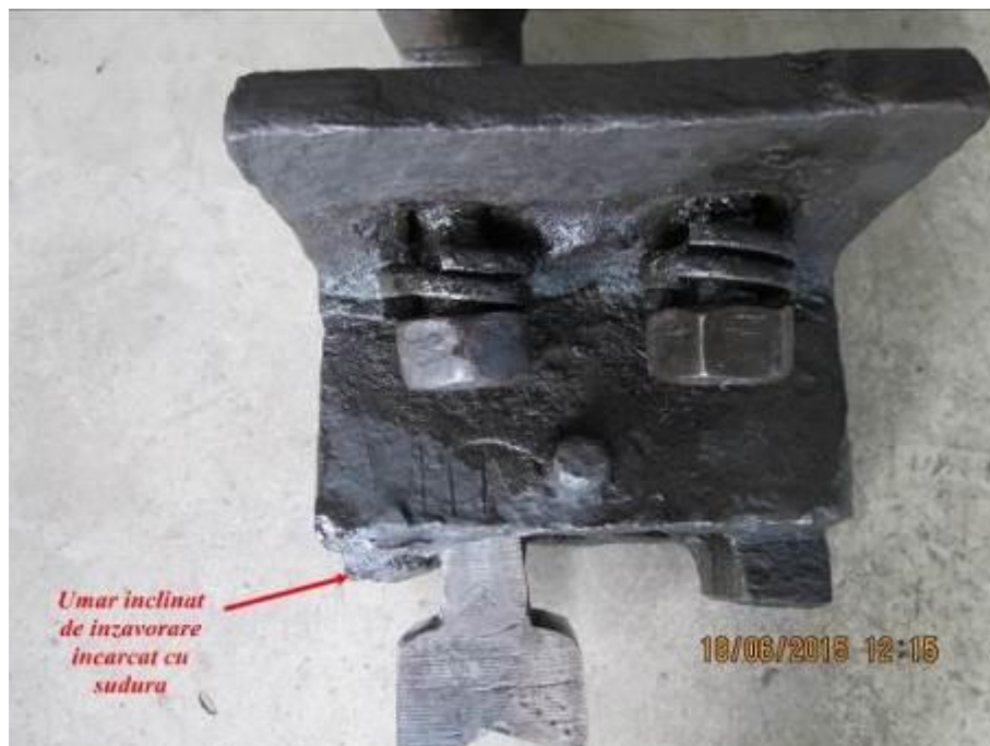
Foto nr.42– Casetă de înzăvorâre de la fixătorul de mijloc partea stângă în sensul de mers tren, montată pe contraacul curb (înzăvorâre ac drept) lângă o casetă de înzăvorâre nouă
