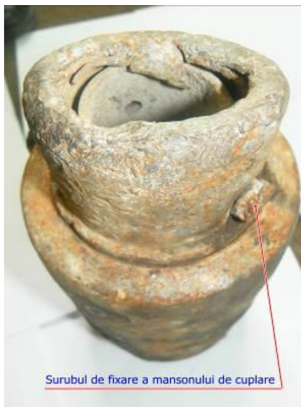
Fig.7 Corpul carterului regulatorului de timonerie SAB tip FE, poz.8, Fig.5
