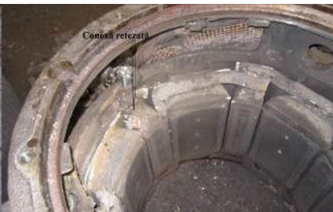
Fig. 6 – Conexă retezată
