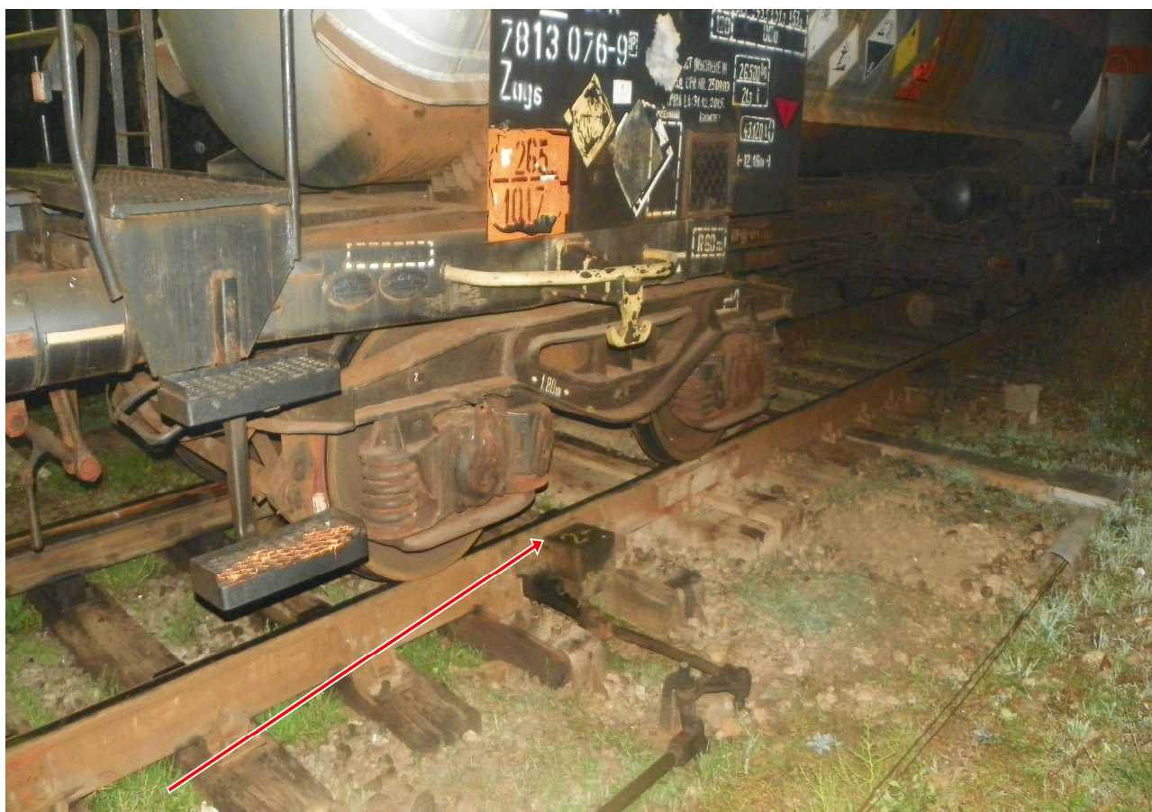
Fig.1 Vagonul al 3-lea în sensul de mers, cu ultima osie pe macazul nr.2 în dreptul încuietorilor.
