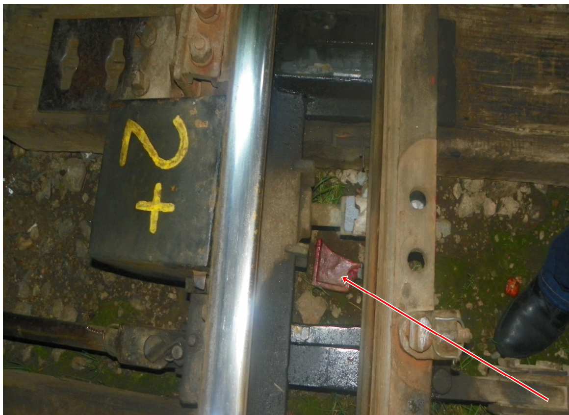
Fig.2 Ciocul rupt la încuietoearea pe „+” a macazului nr.2
