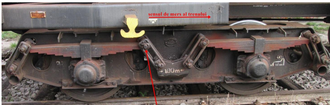
Fotografia nr.12 - Boghiu tip H cu marcarea poziției unde s-a produs ruptura foii principale
