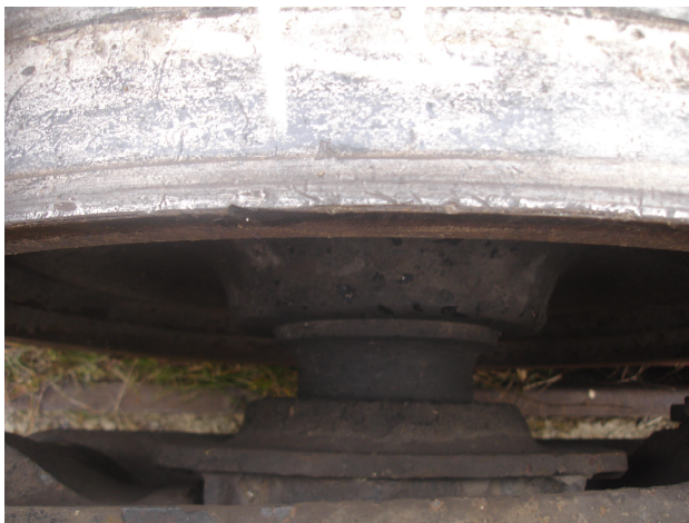
Foto - roata 7 - fixare butuc roată pe axa osiei
