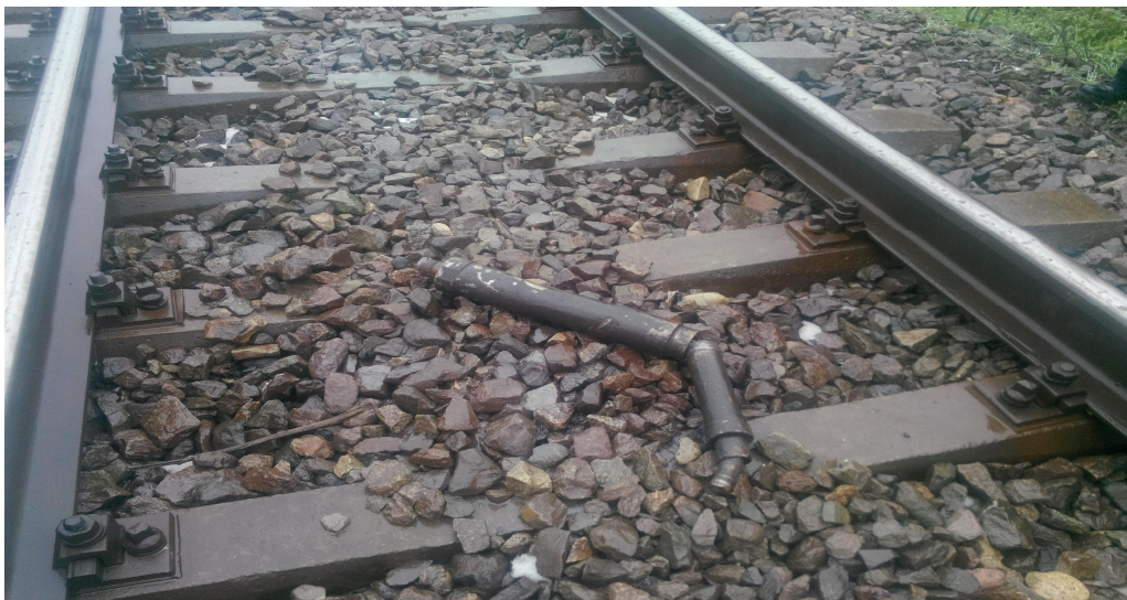
Fig. 3 Poziția în care a fost găsit căzut regulatorul automat de timonerie SAB
