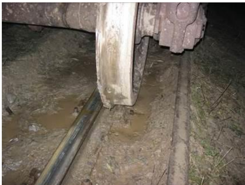
Foto nr.6 Roata din dreapta a osiei IV, în sensul de mers, de la vagonul al 3-lea, după escaladarea șinei corespunzătoare firului interior al curbei și căderea în exteriorul căii, pe partea dreaptă
