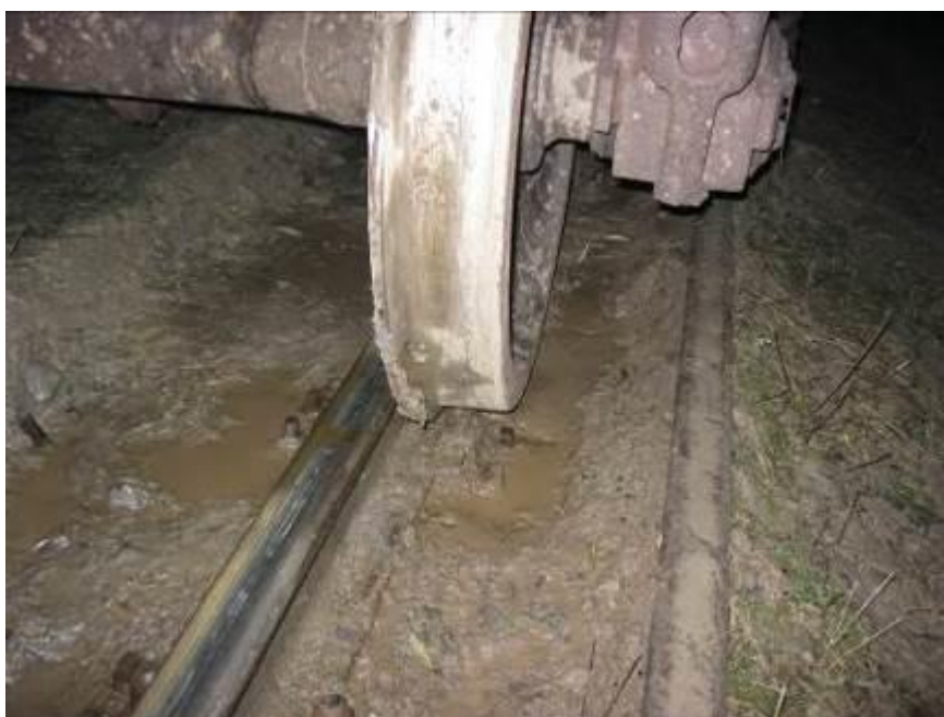
Foto nr.6 Roata din dreapta a osiei IV, în sensul de mers, de la vagonul al 3-lea, după escaladarea șinei corespunzătoare firului interior al curbei și căderea în exteriorul căii, pe partea dreaptă
