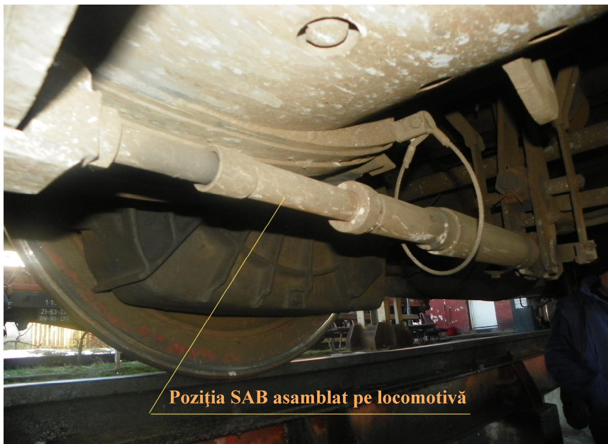
Fig. 2 Poziția regulatorului SAB montat pe locomotivă
