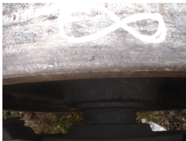
Foto – roata 8 - fixare butuc roată pe axa osiei
