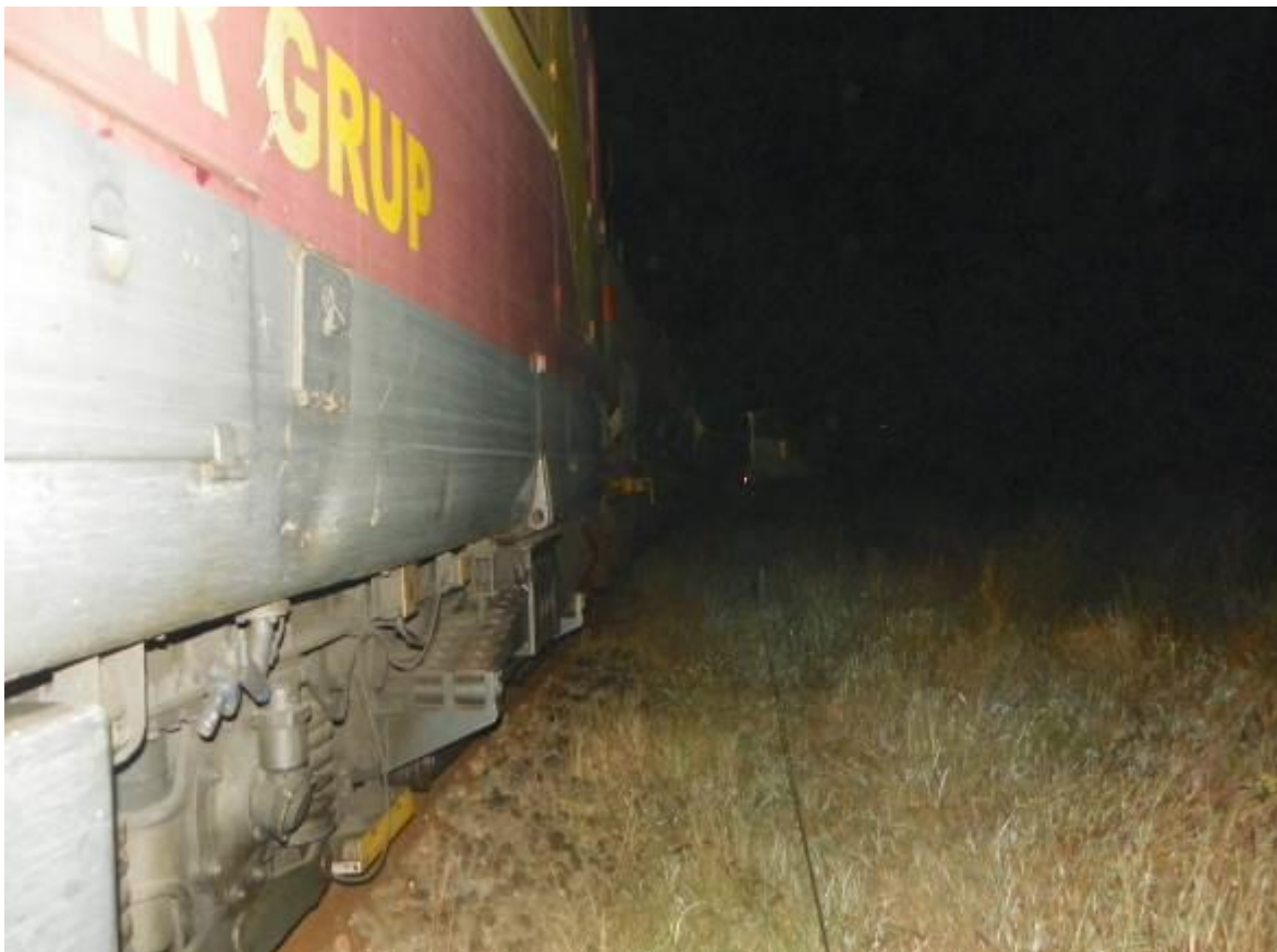
Fig.5 Locomotiva și 3 vagoane care au depășit schimbătorul de cale nr.2
