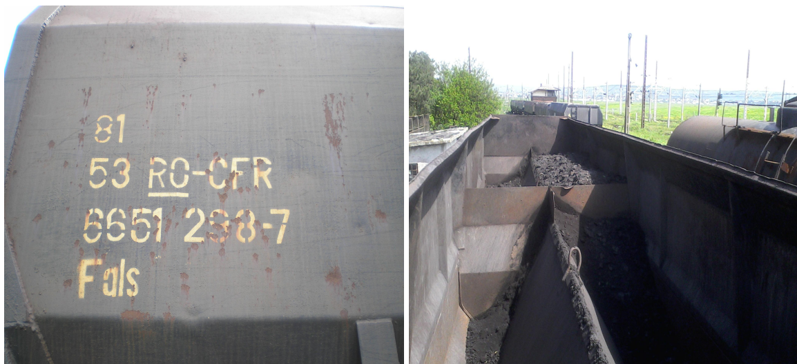
Foto 6: Compartimentul din față partea dreaptă a sensului de mers rămas nedescărcat la primul boghiu în sensul de mers
