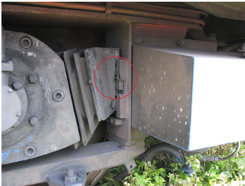
Foto 9 - adaosurile de cântărire ieșite din poziția normală
