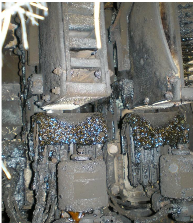
Fig.5. Contactori de linie MT3
