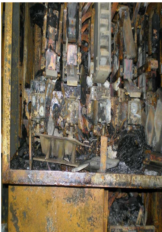
fig. 4 Blocul S3 contactori de linie și frânare
