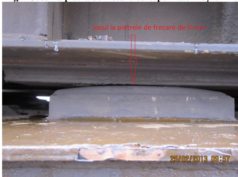
Fig.5 Jocul la piatra de frecare corespunzător roților 1-3
