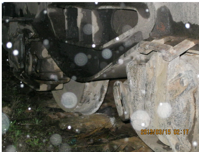
Fig. nr. 3- roțile 6-8 deraiate în exterior
