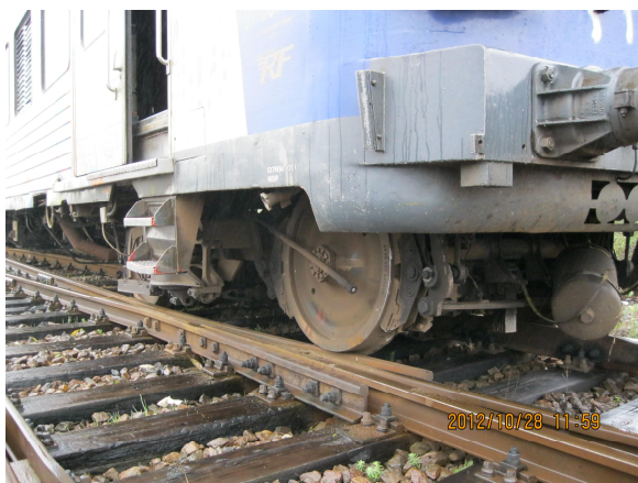
Fig.3. Boghiul nr.1 automotor
