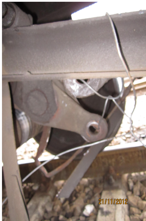
Fig.9 si 10 – axa triunghiulară lipsă sub vagon la sosirea comisiei de investigare – ambii etrieri exteriori de siguranță deformați și cu ranforsările rupte aproximativ 90% pe lungimea cordonului de sudură
