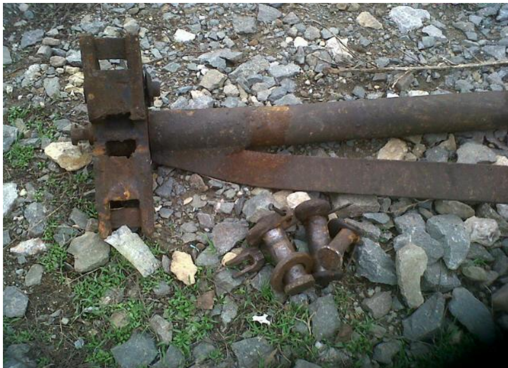
Fig.3 Capătul dreapta al axei triunghiulare – jugul axei torsionat și rupt, urme de frecare în cepul dreapta în urma contactului cu buza roții nr.6
