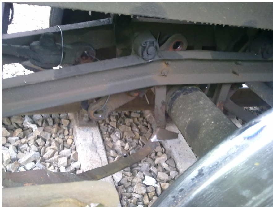
Fig.8 Buza bandajului roții nr.6 – urme de frecare puternică în cepul axei triunghiulare (luciu metalic și pete de culoare vineție)
