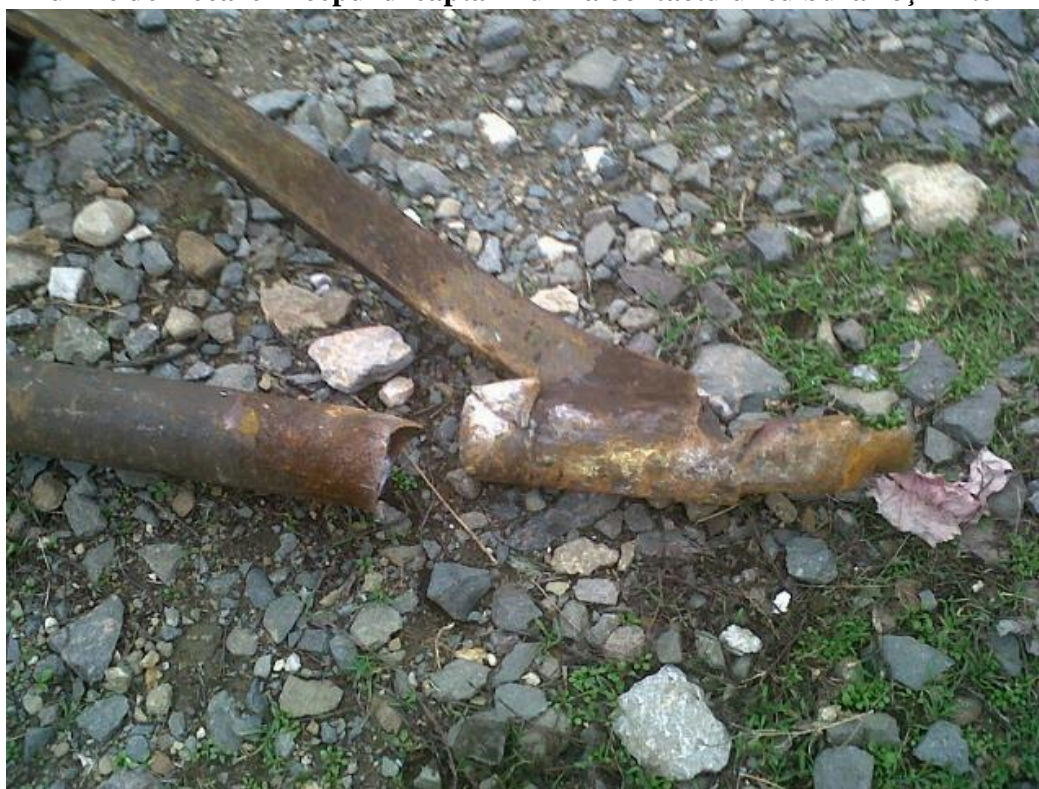
Fig.3 Capătul dreapta al axei triunghiulare – jugul axei torsionat și rupt, urme de frecare în cepul dreapta în urma contactului cu buza roții nr.6
