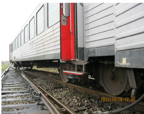
Fig.5. Remorca de automotor nederaiată pe linia 4
