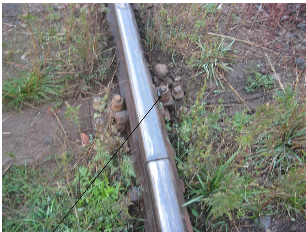
foto nr. 3 – primul bulon vertical lovit de roata din partea dreaptă
