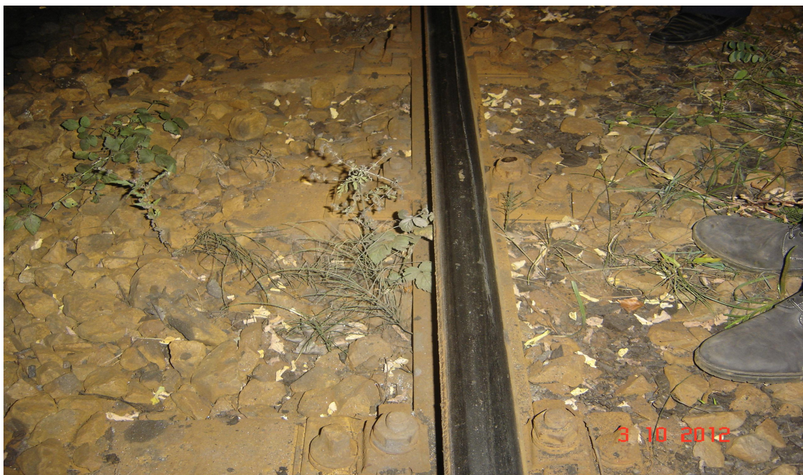
Foto 2. urmele lăstate de ciuperca șinei de 2 osii care au rulat pe ciuperca șinei.
