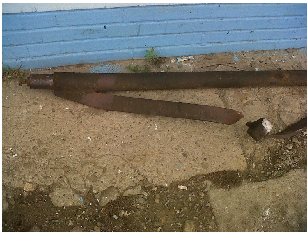
Fig.12 Axa triunghiulară dusă la sediul SC GRAMPET SERVICE după efectuarea reviziei tehnice la sosire în stația CF Palas
