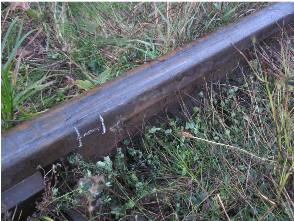
foto nr. 1 - urma de rulare și cădere a roții din partea stângă
