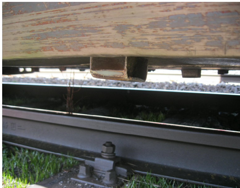
Fig. 7 – Urme de lovire pe suportul de repaus al rezervorului, din față sens mers
