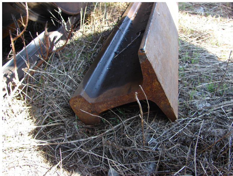
Fig. 2 – Urmele de lovire și de scurgeri de motorină pe cuponul de șină
