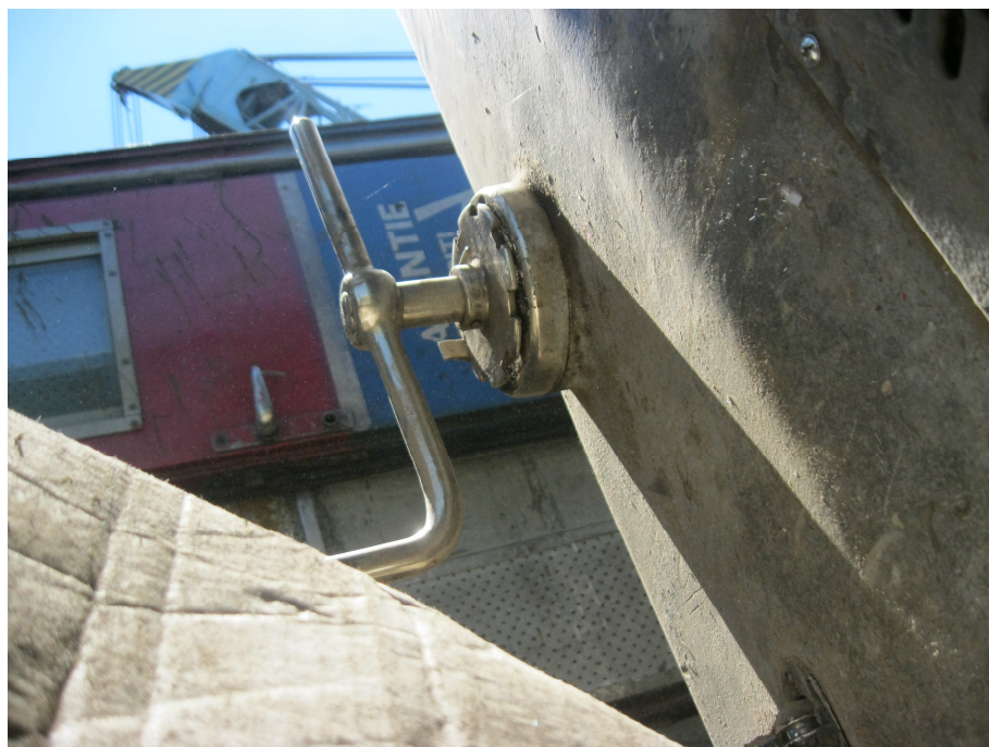
Fig. nr. 7 – Frâna de mână a locomotivei din postul de conducere II asigurată în poziția de slăbire
