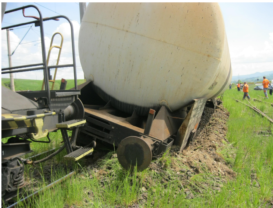
foto nr. 14 – tampoanele din față ale vagonului deraiat
