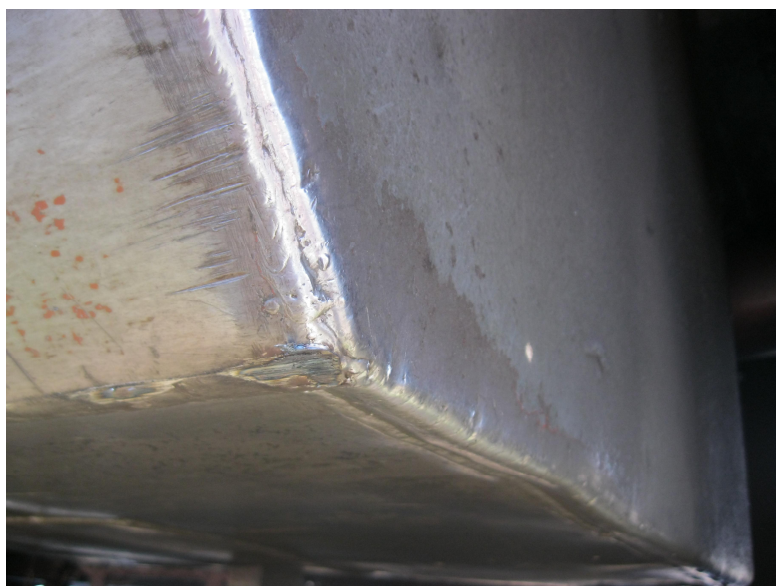
Fig. 6 – Urme de lovire pe colțul rezervorului de combustibil
