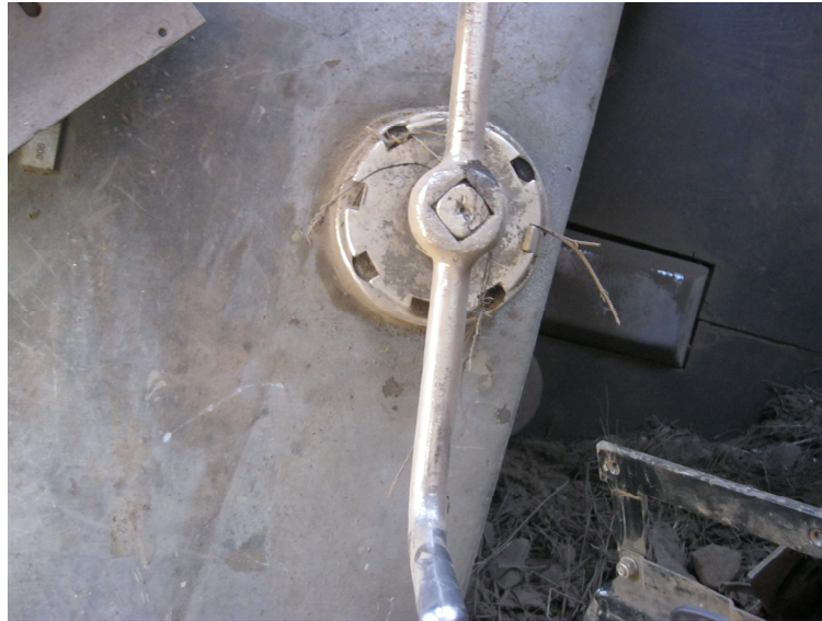
Fig. nr. 4 – Frâna de mână din postul de conducere I asigurată în poziția de slăbire
