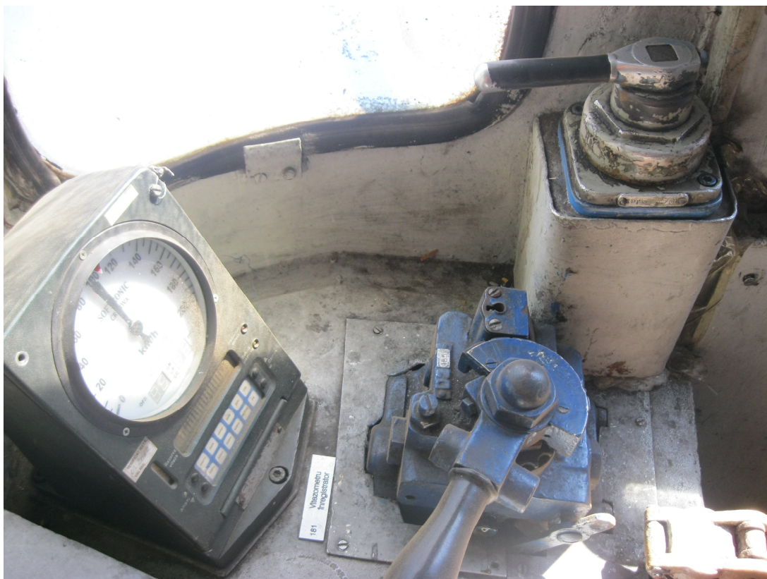
Fig. nr. 5 – Robineții KD2 și FD1 din postul de conducere I
