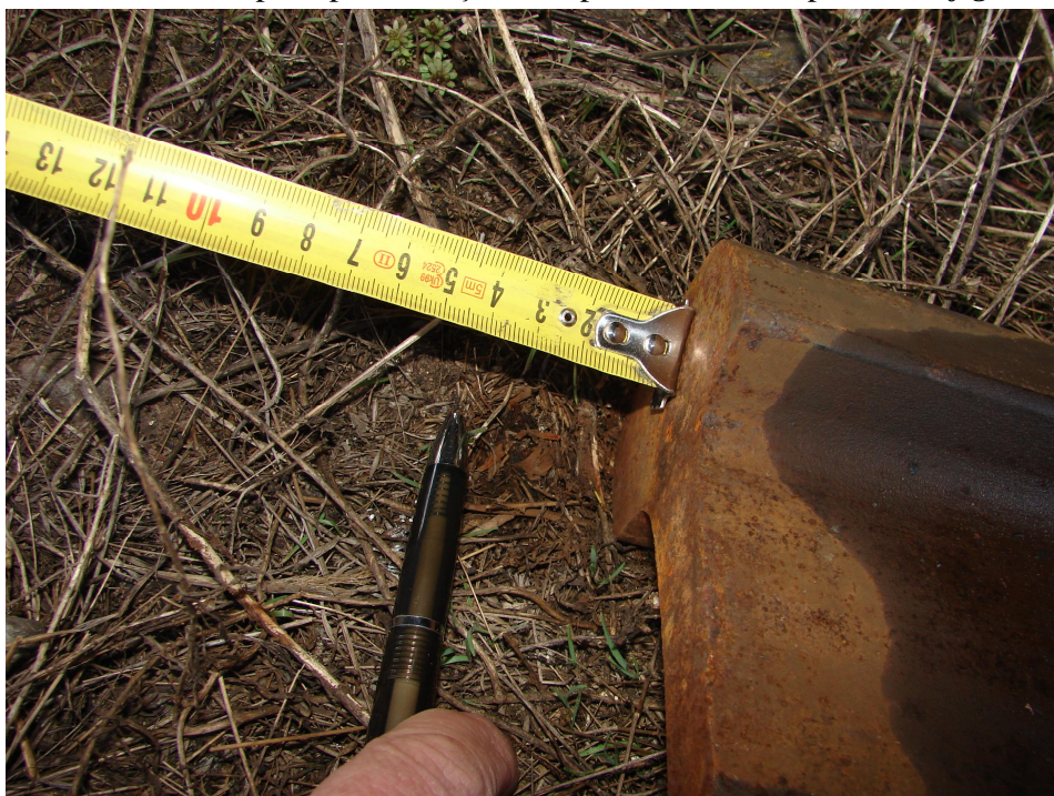
Fig. 1 – Deplasarea longitudinală a cuponului de șină aflat în gabarit
