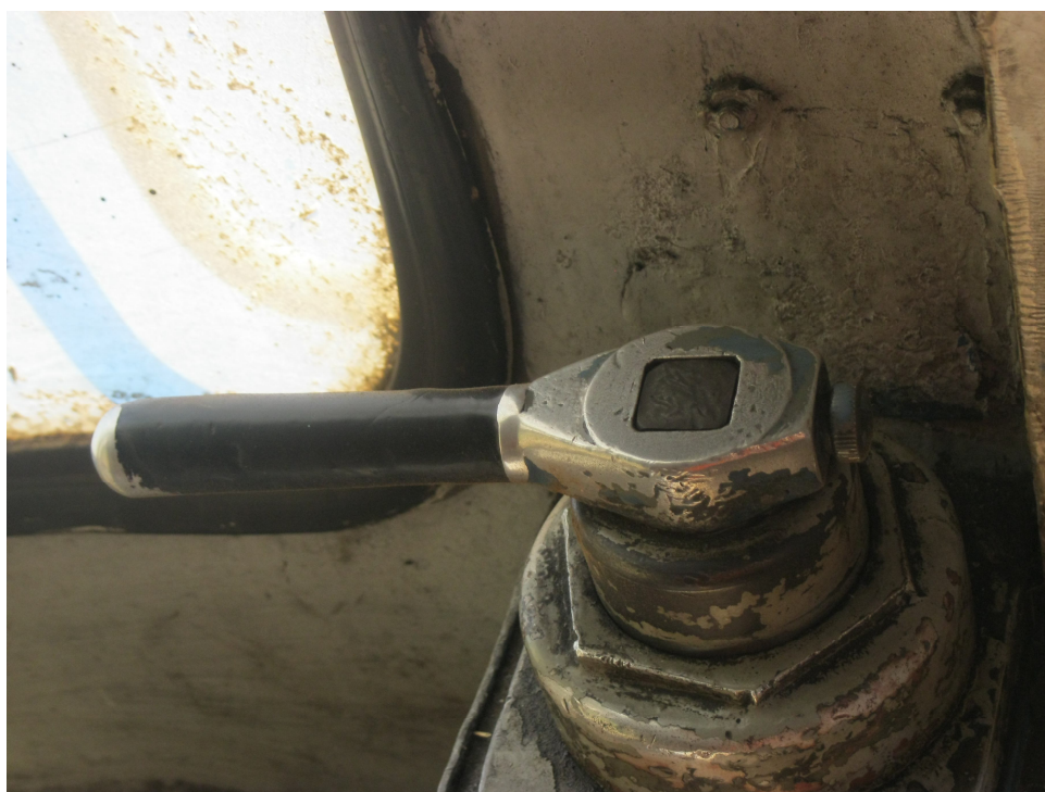
Fig. nr. 6 – Robinetul frânei directe a locomotivei din postul de conducere I în poziția de slăbire
