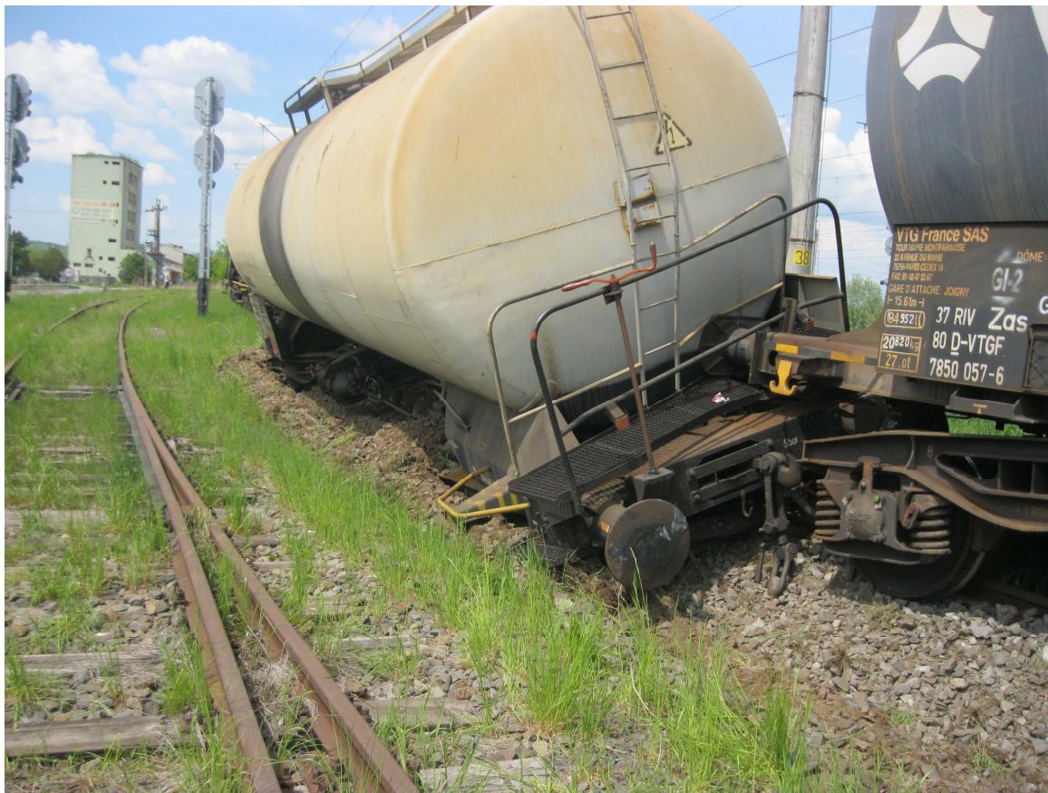
foto nr. 15 – tampoanele din spate ale vagonului deraiat
