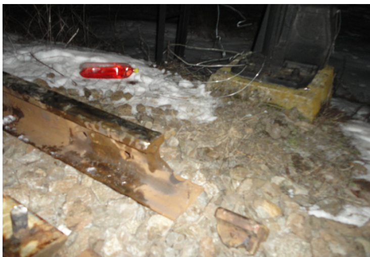
Foto 2 : Capătul rupt al șinei din alcătuirea joantei izolante lipită
