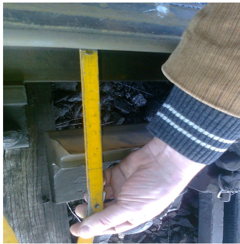
Figura nr.2 (macaz neînzăvorât - cursă de înzăvorâre incompletă)
