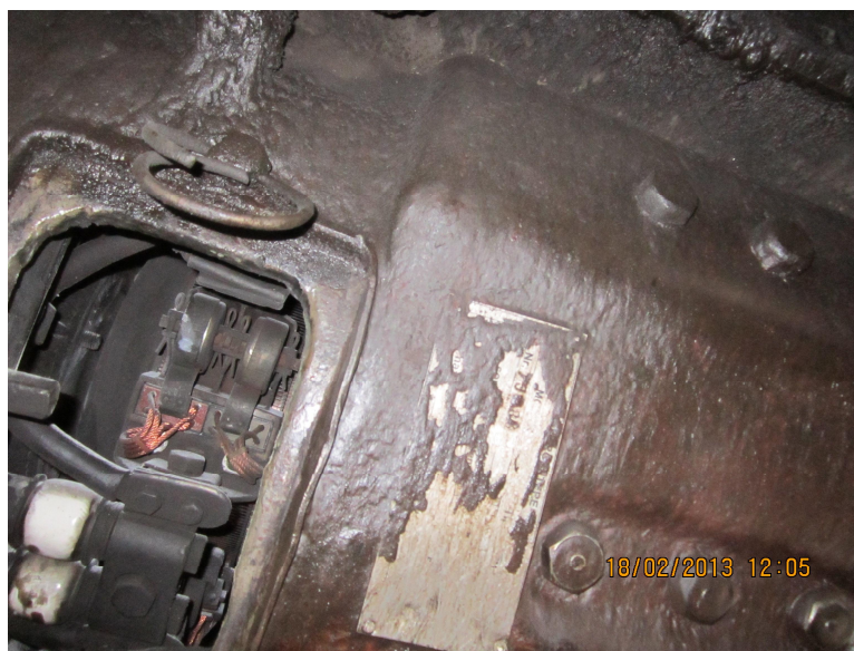
Fig.9 Starea de curățenie a motoarelor de tracțiune
